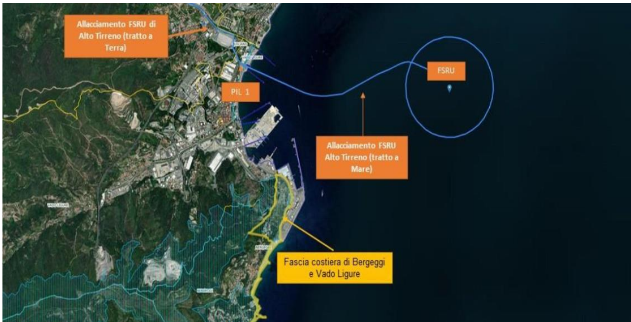
Figura 3 Mappa delle opere offshore e allacciamento FSRU Alto Tirreno - tratto a terra (fonte: SIA progetto FSRU Alto Tirreno e collegamento alla Rete Nazionale Gasdotti, sezione I, cap. 2).
