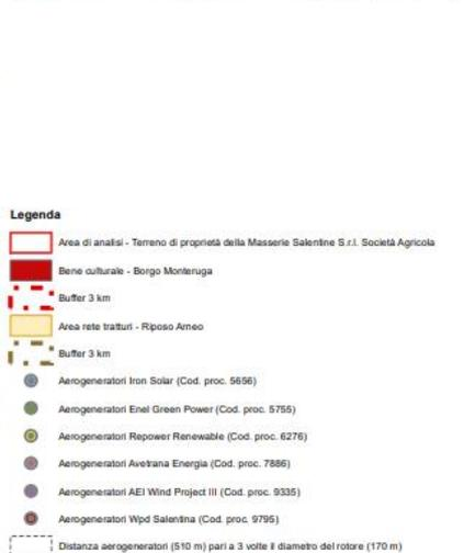
*Distanza aerogeneratori (510 m) pari a 3 volte il diametro del rotore (170 m)*
