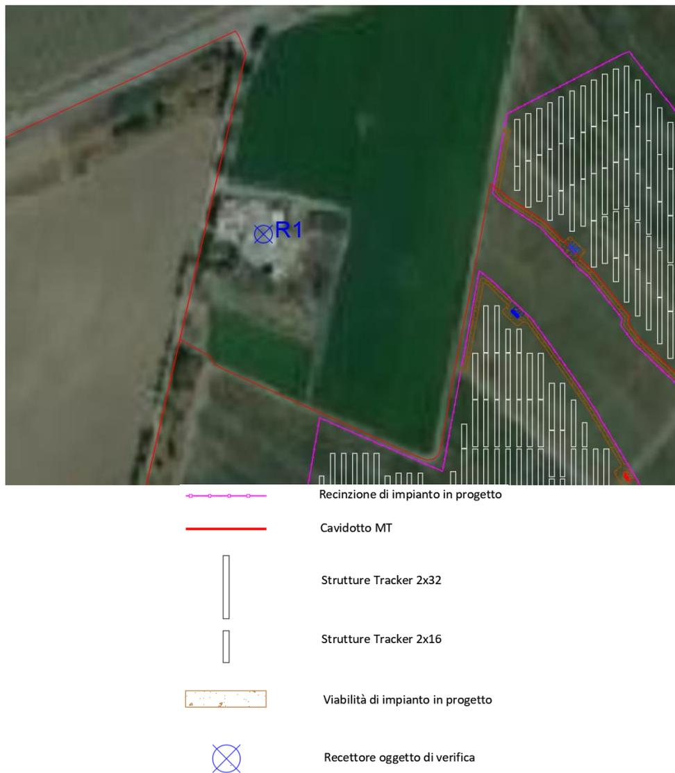
Figura 17: Inquadramento su base satellitare del recettore R1 rispetto al layout di impianto
