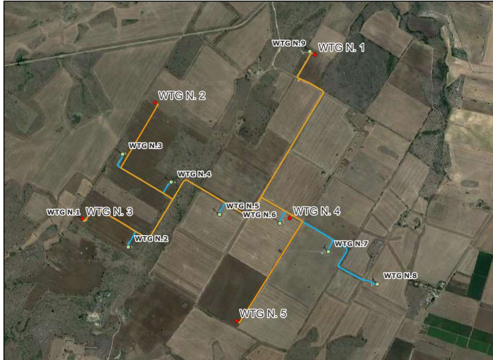
Stralcio su ortofoto dei tracciati del cavidotto dell'impianto esistente in blu e del nuovo impianto in grigio
