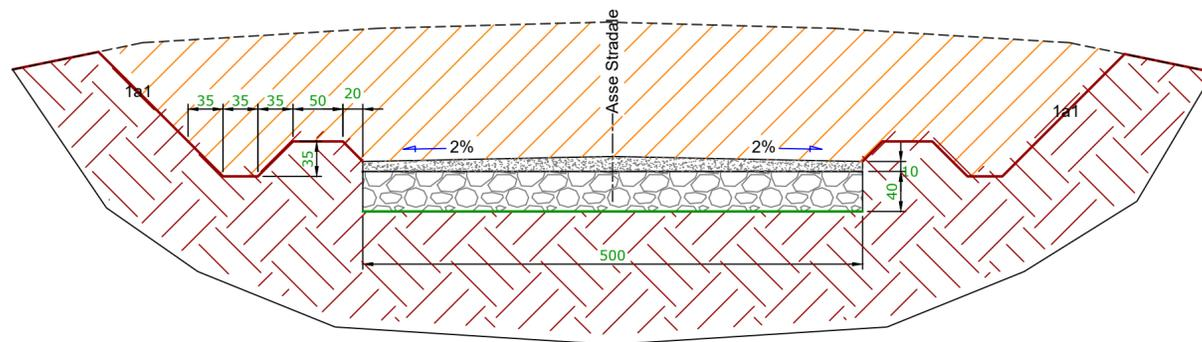
SEZIONE TIPICA GENERICA IN RILEVATO
