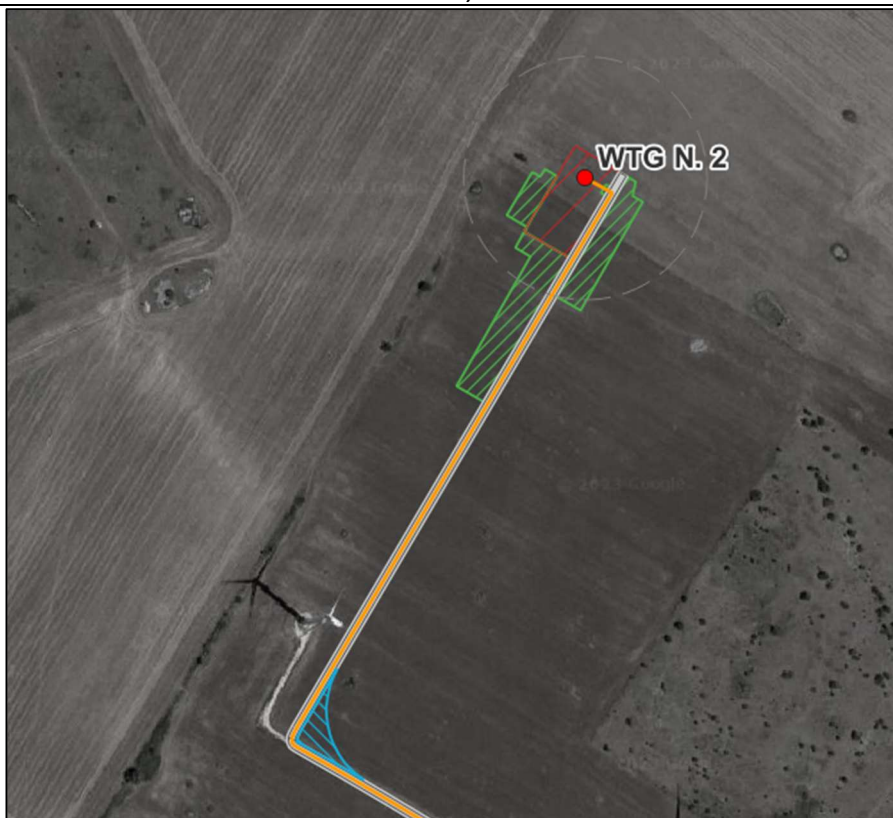
WTG 2 – Piazzola temporanea (in verde), permanente (in rosso) e viabilità di accesso (in grigio), slarghi (in blu)
