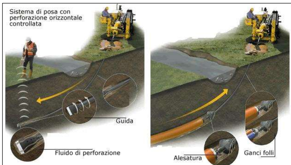
Posa in opera tubazione per alloggiamento cavi
