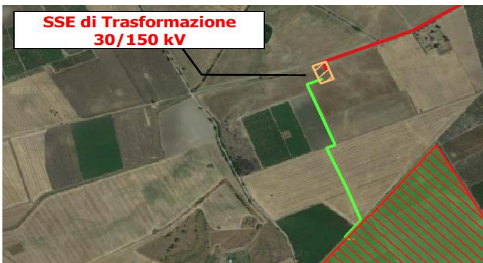
Figura 2: SSE Trasformazione e cavidotto MT (in verde) dalla CdR nell'area di impianto
