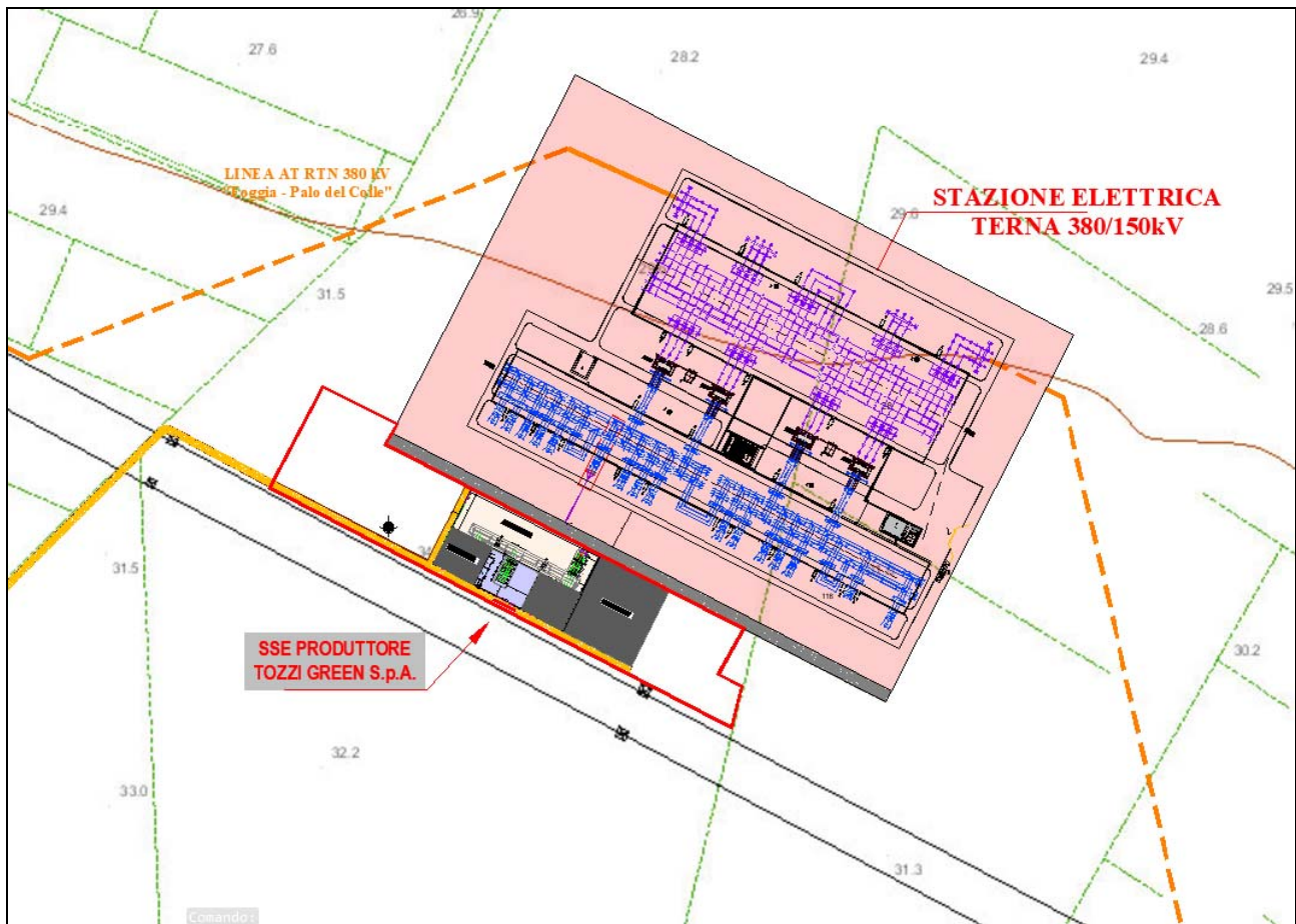
Fig. 6 – Planimetria generale su base CTR riportante il mutuo posizionamento della SSE di Tozzi Green SpA, delle altre SSE condividendo lo stallo e della SE-RTN di “Cerignola”
