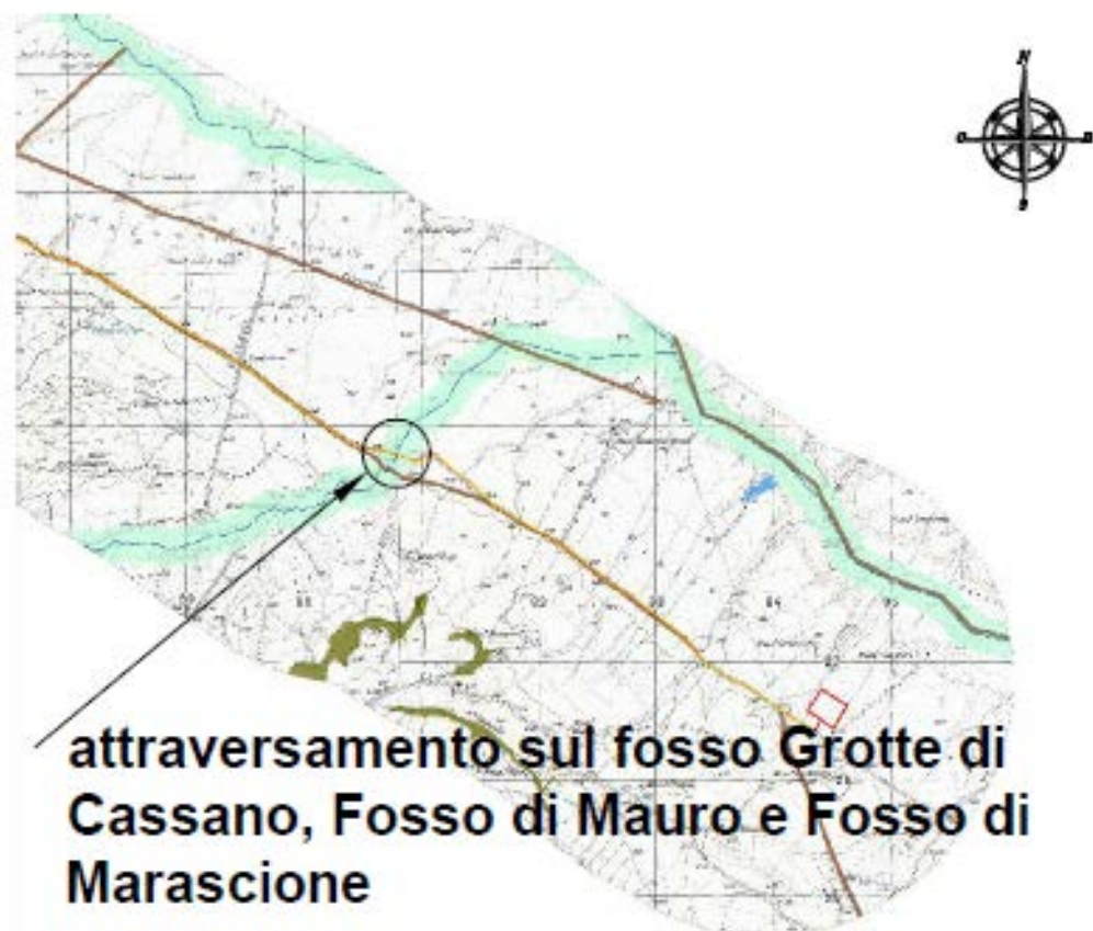
Fig. 7 – inquadramento su I.G.M. del punto in cui il cavidotto in AT sotto la SP 79 interferisce con l'asta pubblica n. 416 tutelata ai sensi del D.Lgs. n. 42/2004, art. 142 co. 1 lettera c).
