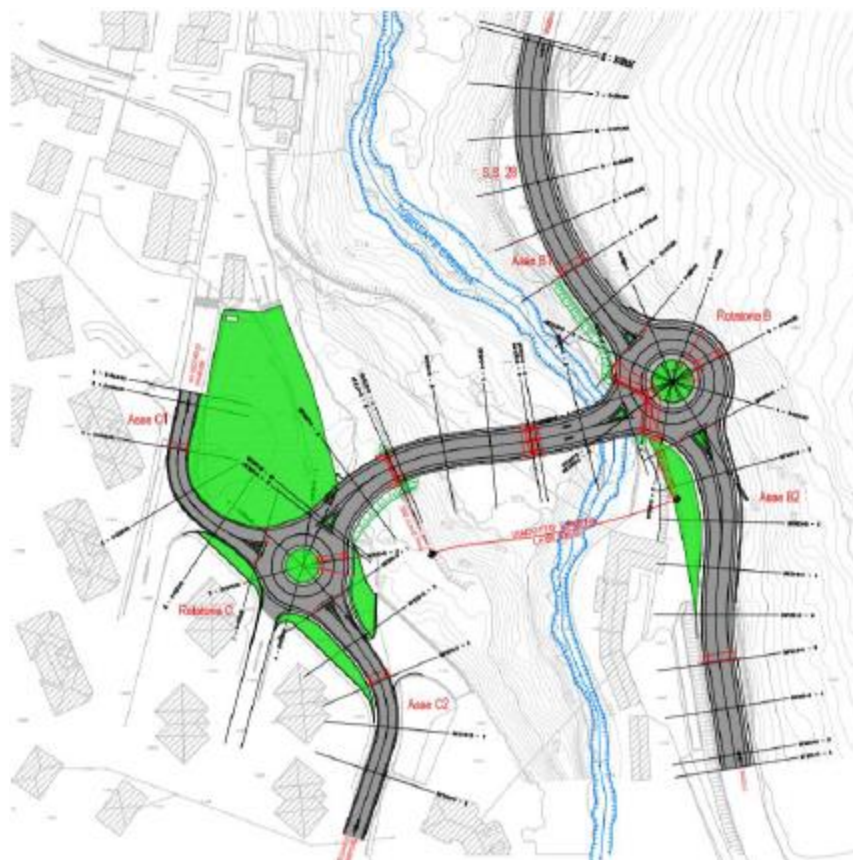
Figura 2 – Asse secondario – collegamento Rione Borgato con S.S. 28
