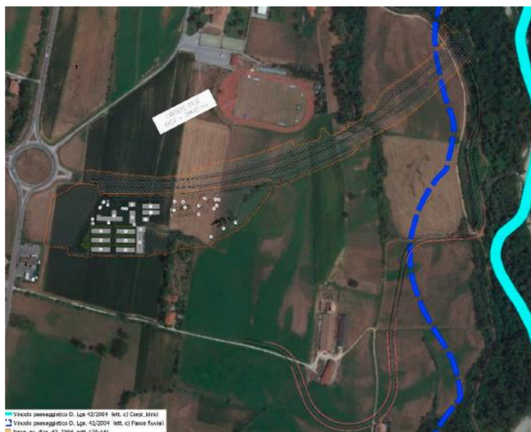
Figura 8 – Asse principale – Layout cantiere base - Vincoli
