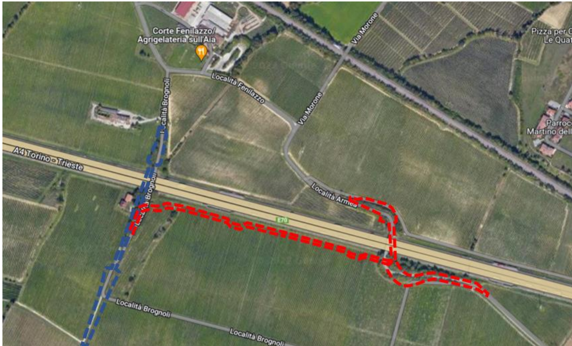
Variante M55: individuazione variante su ortofoto – Raffronto tra Progetto Definitivo (schematizzazione in blu) e Progetto Esecutivo (schematizzazione in rosso)
