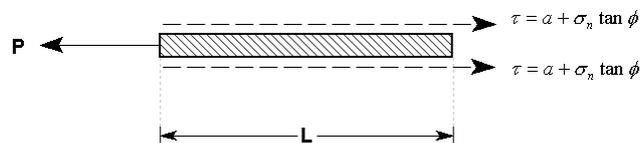
**Figura n.8.4 – Resistenza allo sfilamento**
