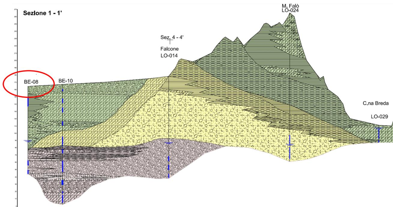
*Figura 3.8: Sezione 1-1'. Da "SG-Tav.7 – Sezioni idrogeologiche e geologiche", elaborato compreso negli elaborati di carattere geologico a corredo del PGT del Comune di Lonato del Garda (2009). L'area di realizzazione dell'impianto agrivoltaico è localizzata nei pressi della captazione "BE-08".*
