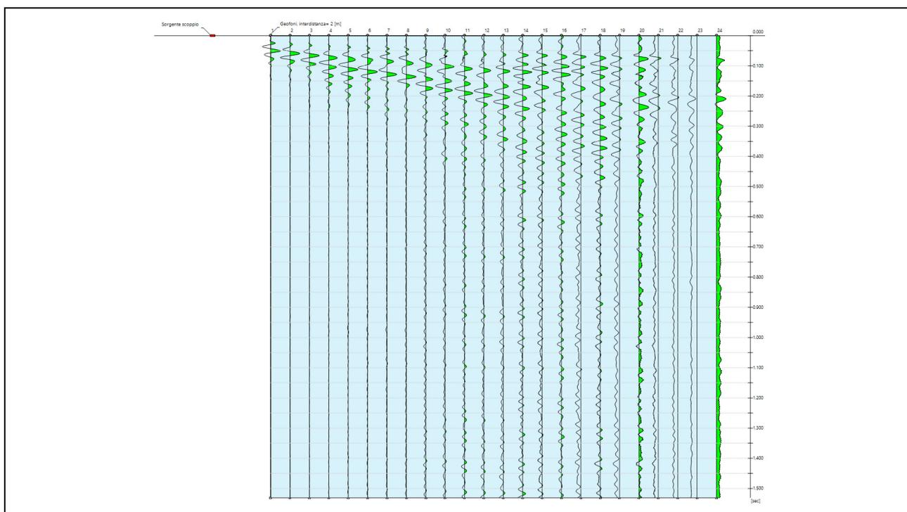
Figura 2: rappresentazione delle tracce registrate adottando lo stendimento a 24 geofoni. Sorgenti sismiche poste a -2,0 m a -5,0 m e a -10,0 m dal geofono G24.
