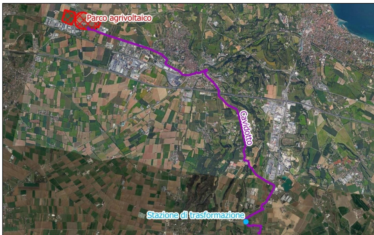
Figura 5-1: Planimetria dell'impianto di nuova realizzazione. Si notano il parco agrivoltaico, il cavo interrato e la sottostazione elettrica.
