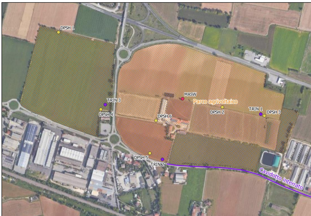
Figura 4.14: localizzazione dei punti d'indagine: MASW (cerchio rosso), DPSH (cerchio giallo), scavi esplorativi (cerchio viola).
