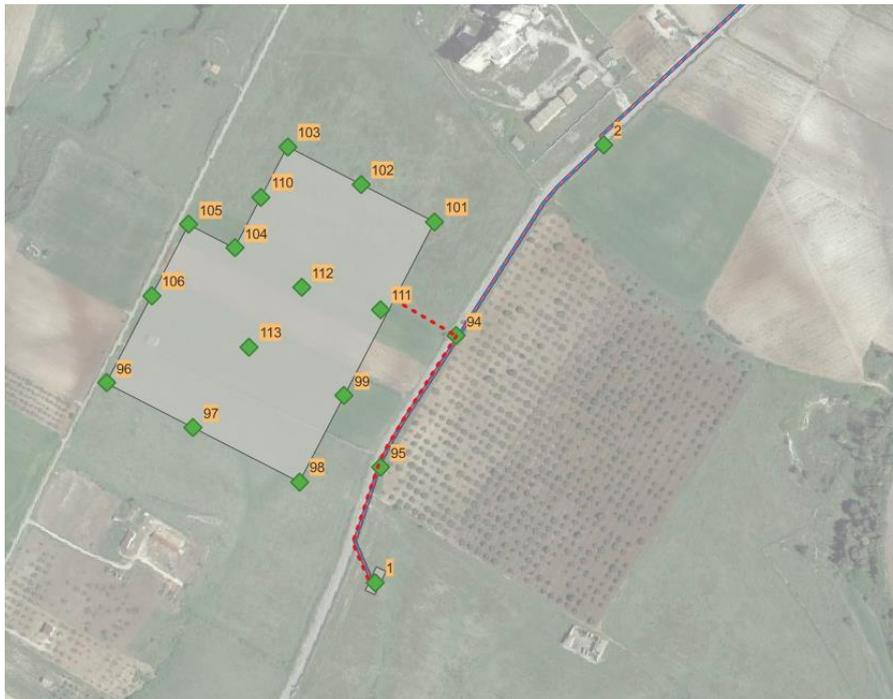
Figura 7. Stralcio planimetrico con indicazione dei punti di campionamento componente suolo e sottosuolo (PMA\_SSO\_CO/PO\_A\_ij)
