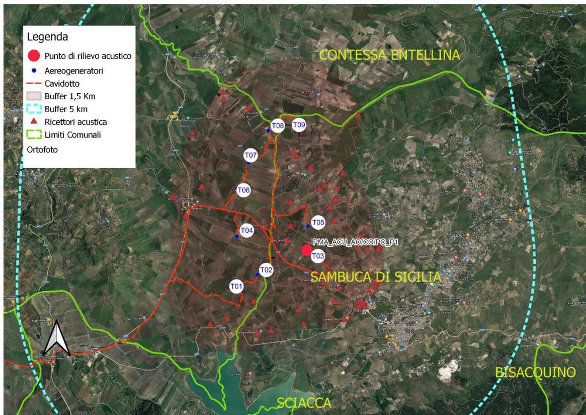
Figura 13. Area di indagine componente rumore – Postazione di misura (P1), aerogeneratori di progetto (T0i) e ricettori.
