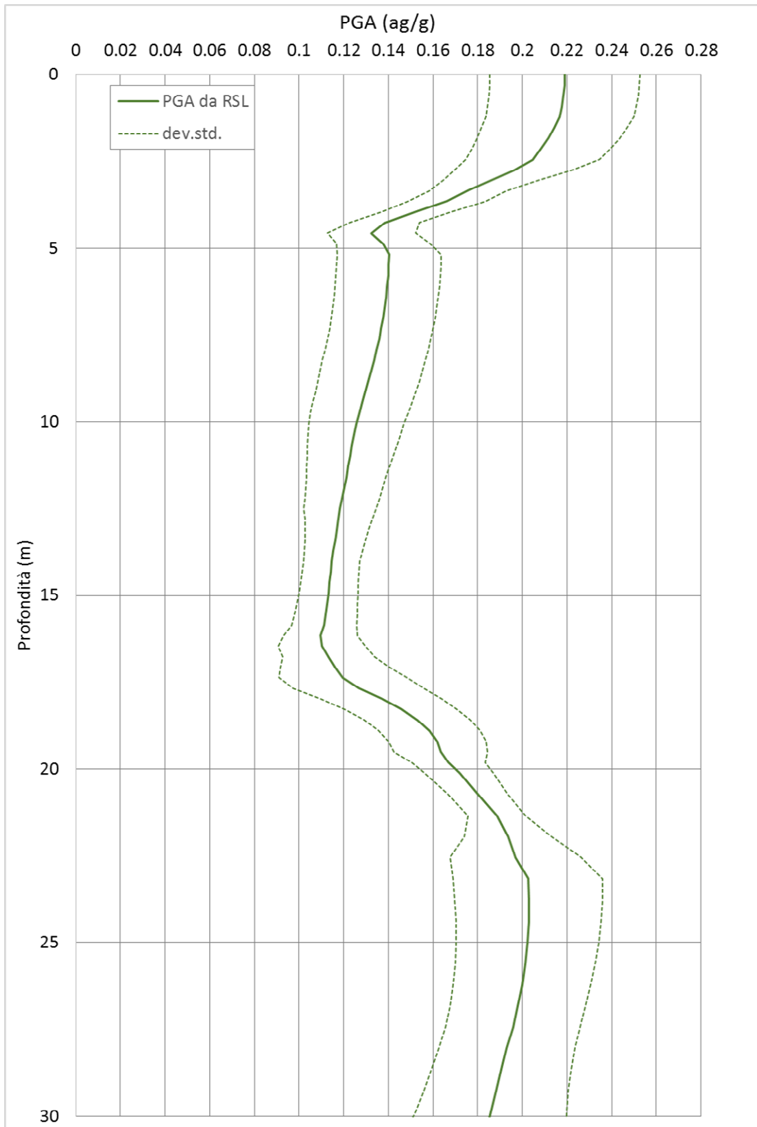
Fig. 33 – Profilo della PGA dal bedrock alla superficie
