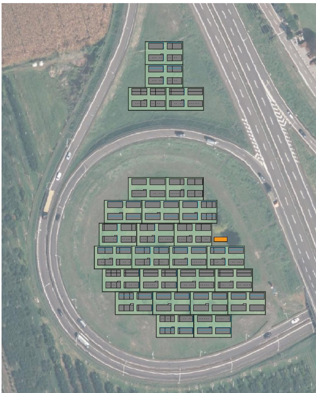
PLANIMETRIA SU ORTOFOTO CON SCHEMA INSTALLAZIONE IMPIANTO FOTOVOLTAICO
