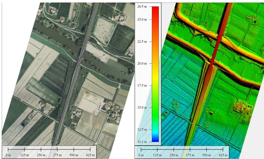
Figura 17 – A Sinistra ortofoto dell'attraversamento autostradale e a destra DTM
