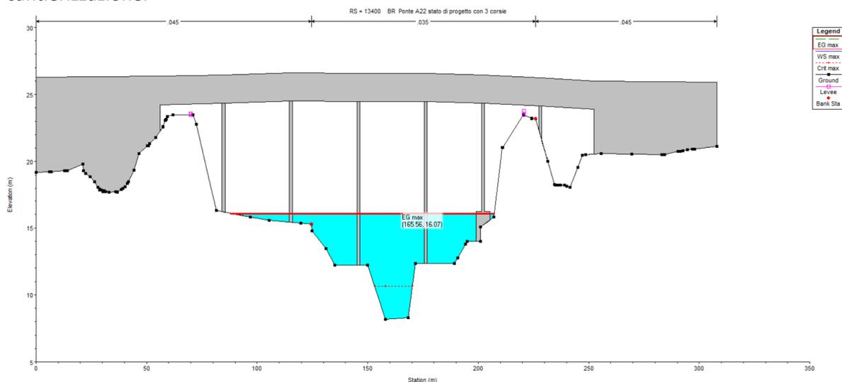
**Figura 21. Sezione trasversale in corrispondenza dell'attraversamento dell'A22 sul fiume Mincio – Stato di cantierizzazione. Tirante idrico 16.07 m s.l.m.**
