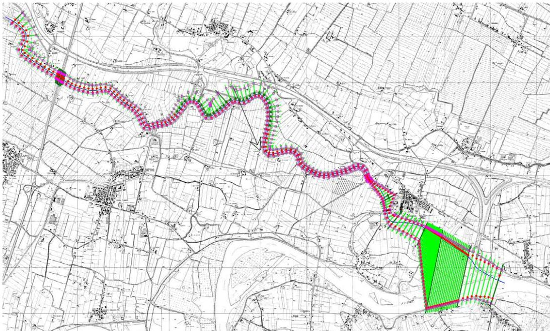
**Figura 11 - Planimetria del tratto di Fiume Mincio modellato con la presenza delle sezioni interpolate**
