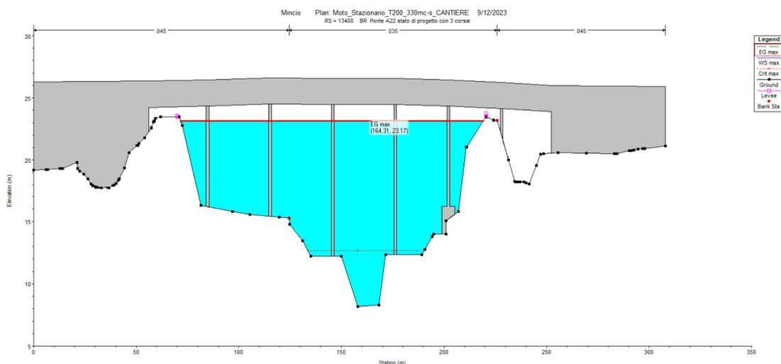
**Figura 19 - Sezione trasversale del ponte dell'Autostrada del Brennero sul fiume Mincio (configurazione transitoria di cantiere) – TR 200 anni – Quota idrica 23.17 m s.l.m.**
