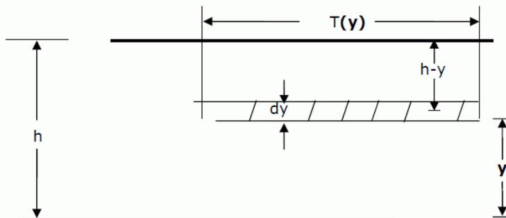
Forze di pressione: la figura mostra il caso generale di una sezione trasversale. La distribuzione della pressione è assunta di tipo idrostatico (varia linearmente con la profondità) e la forza di pressione totale è calcolata come l'integrale del prodotto tra pressione e area sulla verticale della sezione. Dopo Shames (1962), la forza di pressione può essere scritta come:
