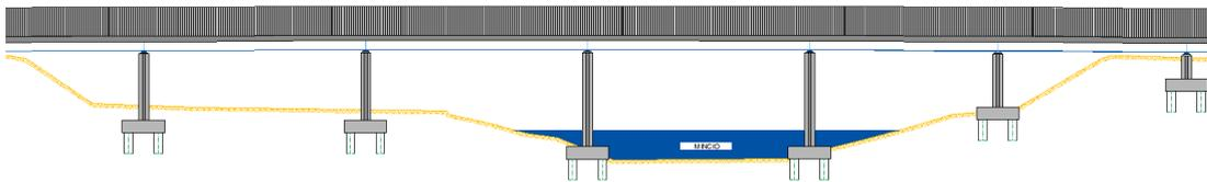
Le spalle vengono completamente ricostruite e si fondano su pali di grosso diametro pari a 1.20 m e lunghezza di 40 m. Esse sono collocate esternamente alla fascia B, in corrispondenza con il rilevato arginale in sinistra idrografica ed esternamente a quest'ultimo in destra idrografica.
