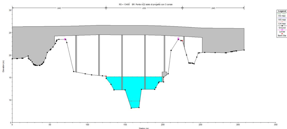
**Figura 22. Sezione trasversale in corrispondenza dell'attraversamento dell'A22 sul fiume Mincio – Stato di cantierizzazione. Tirante idrico 15.17 m s.l.m.**
