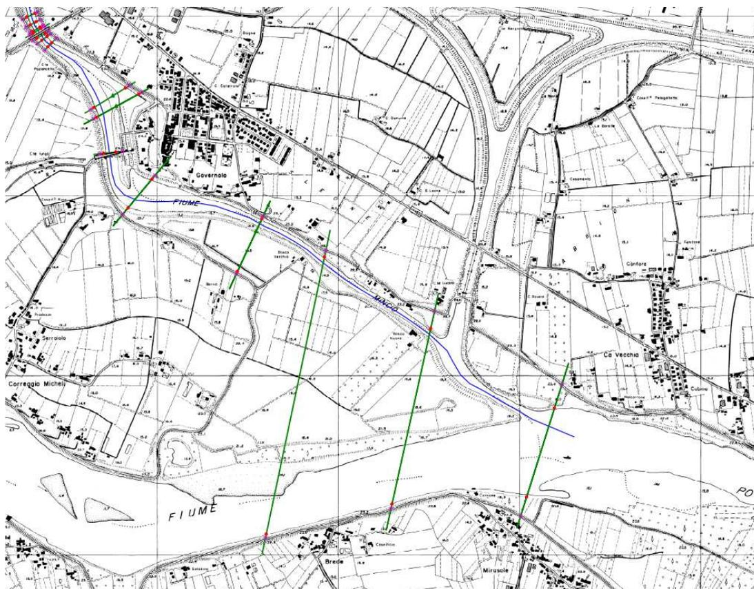
**Figura 6 - Dettaglio delle sezioni trasversali utilizzate nel modello in corrispondenza dell'immissione del Mincio in Po**
