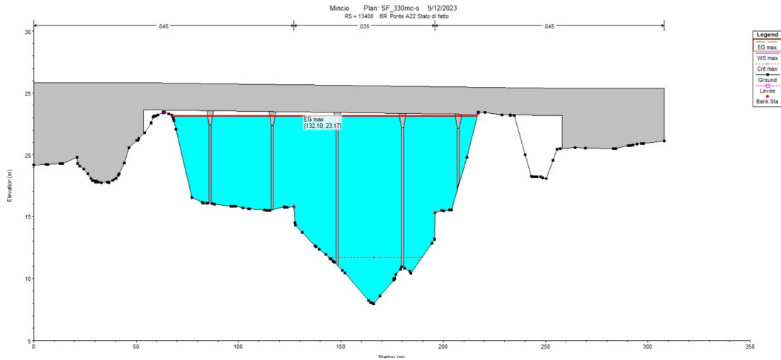
**Figura 10 - Sezione trasversale del ponte dell'Autostrada del Brennero sul Fiume Mincio (configurazione di stato di fatto) – Livello idrico 23.17 m s.l.m. –  $T_R$  200 anni**
