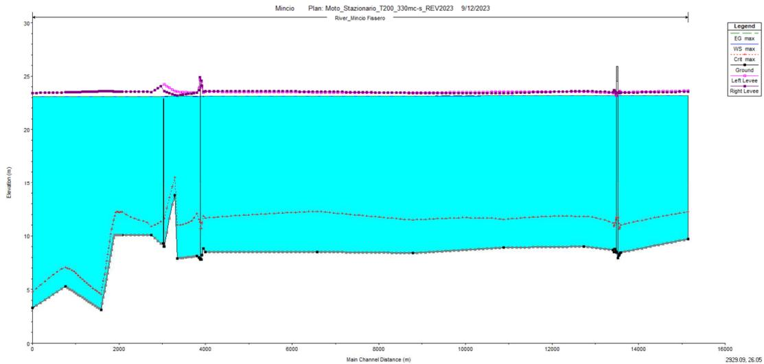
Figura 15 - Profilo longitudinale dell'intero tratto modellato - Configurazione di stato di progetto – T<sub>R</sub> 200 anni
