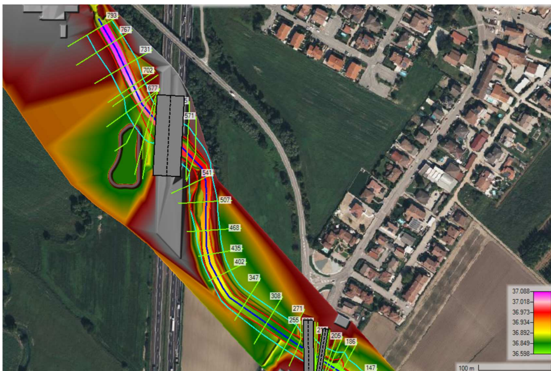
Figura 6-15. Immagine satellitare delle sezioni trasversali e dei tiranti idrici in corrispondenza dell'attraversamento autostradale. – T_R 5 anni
