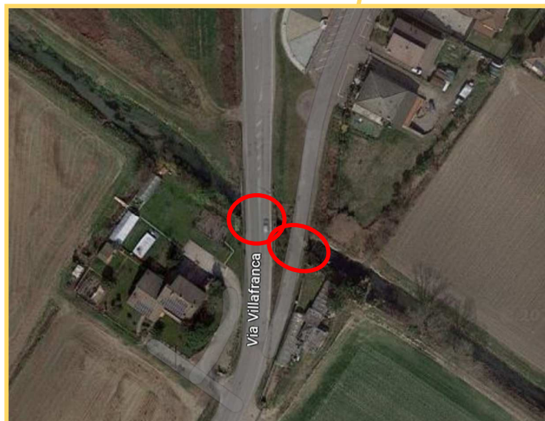
Figura 6-11. Ponti stradali su via Villafranca (SP 24) che fungono da discontinuità idrauliche
