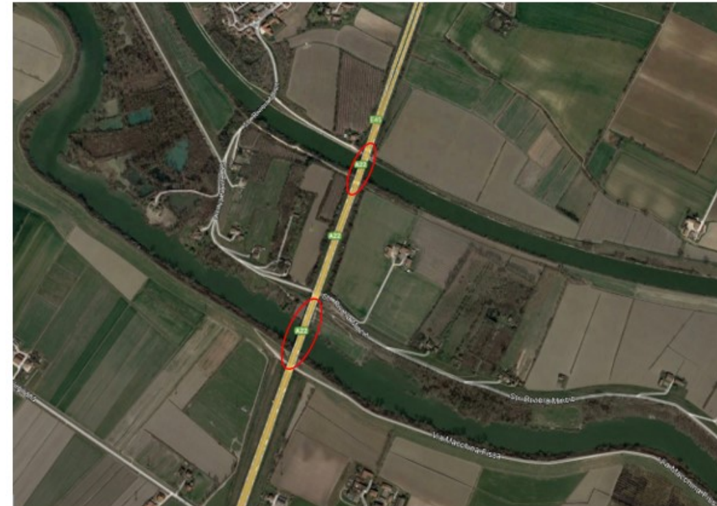
Fig. 8/5.3.1 Localizzazione delle nuove pile e restringimento del Mincio in fase di cantiere
