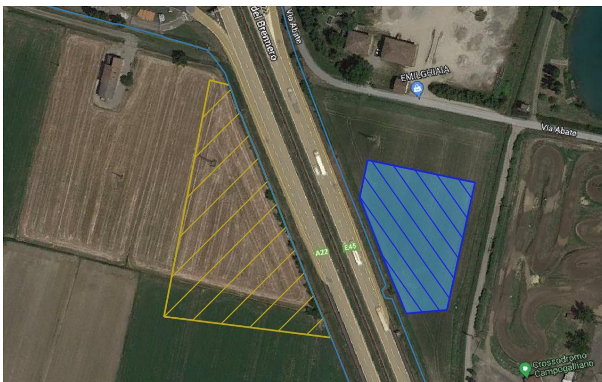
Figura 3: esempio di dataset presenti forniti preliminarmente al rilievo in campo. Le occupazioni temporanee (retino giallo), gli espropri (retino blu), l'area interessata da creazione di un bacino (sfondo azzurro) e il limite della recinzione dell'autostrada (linea azzurra)
