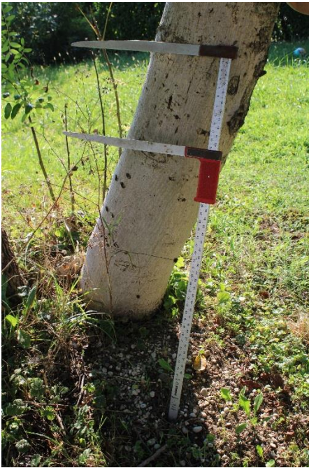
Figura 2: strumentazione impiegata nei rilievi. Cavallo dendrometrico e cordella metrica
