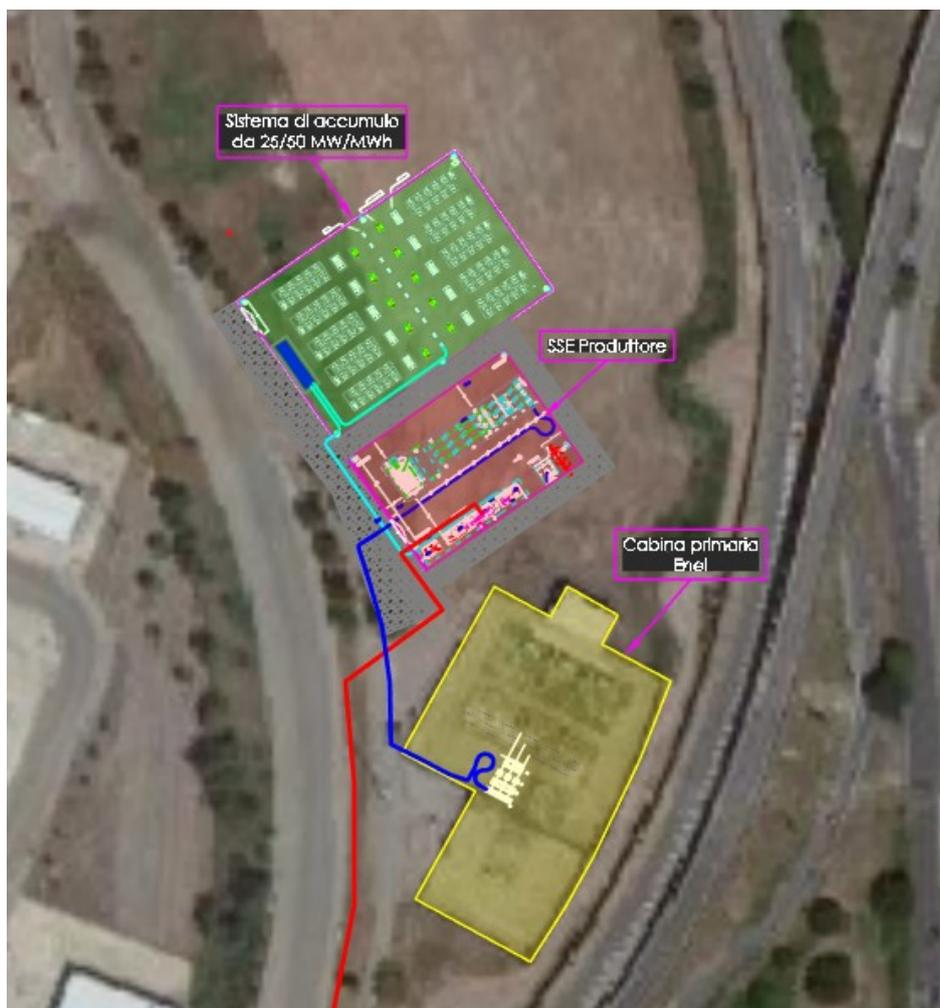
Fig. 27. Inquadramento su ortofoto con ubicazione della Sottostazione Produttore (in rosso), della CP Enel (in giallo) e dello storage (in verde)
