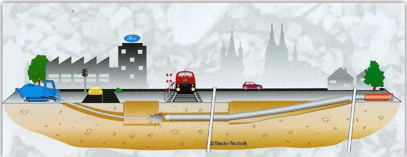
Fig. 9. Schema di principio dell'attraversamento in T.O.C.
