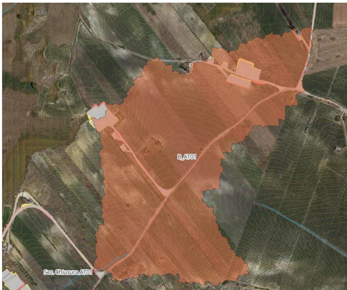
Figura 6.5- Individuazione bacino idrografico sotteso alla sezione di attraversamento – B AT01.
