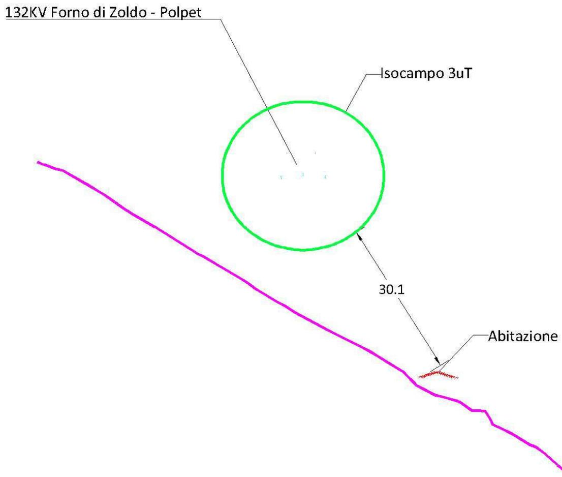
Sezione eseguita alla progressiva 3348 della linea 132KV Forno di Zoldo - Polpet (campata 41-42)
