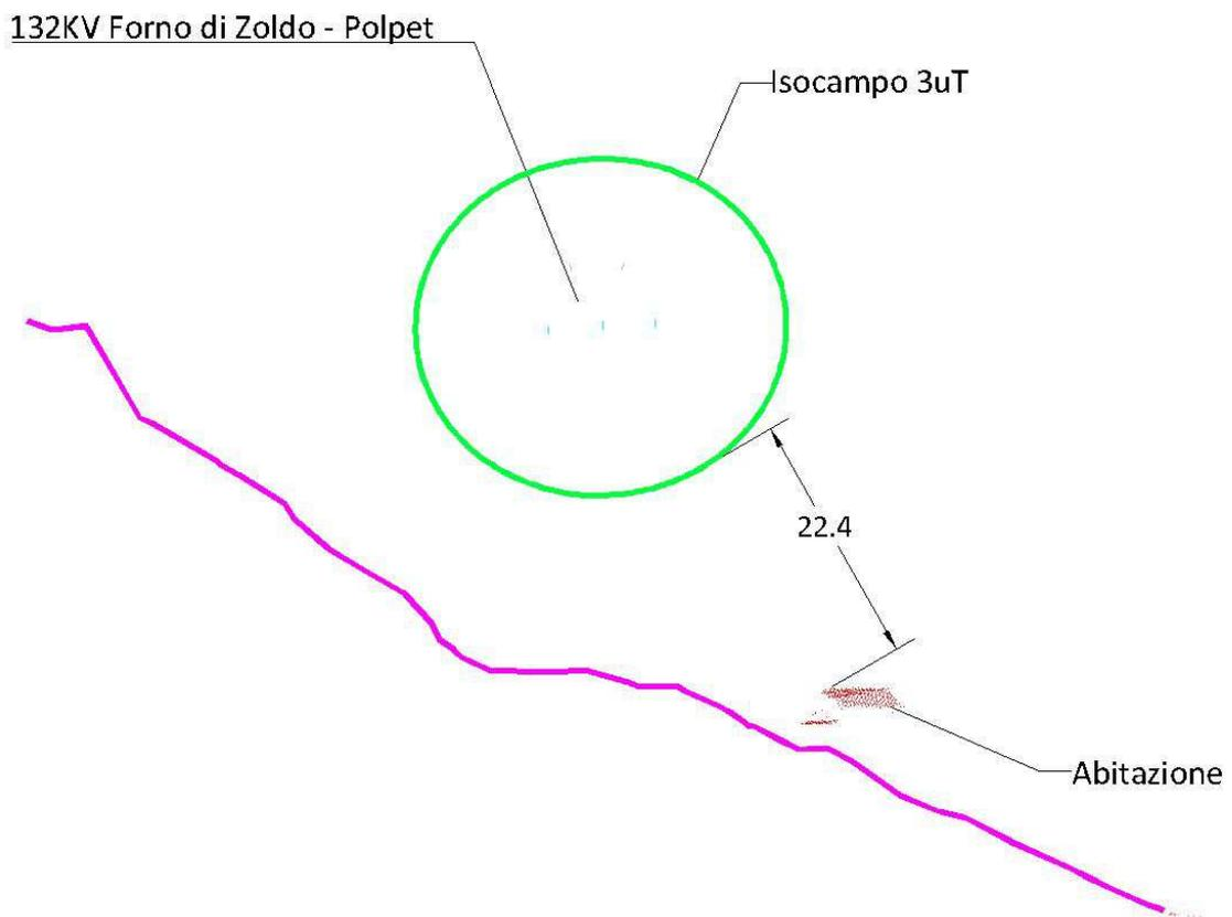
Sezione eseguita alla progressiva 4369 della linea 132KV Forno di Zoldo - Polpet (campata 44-46)
