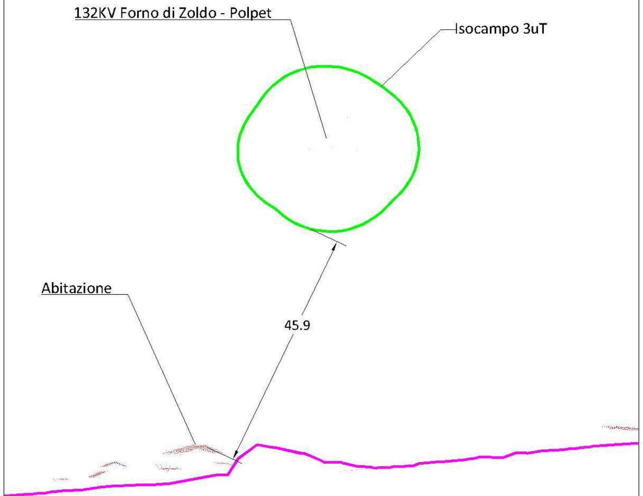
Sezione eseguita alla progressiva 13714 della linea 132KV Forno di Zoldo - Polpet (campata 80 - 81)
