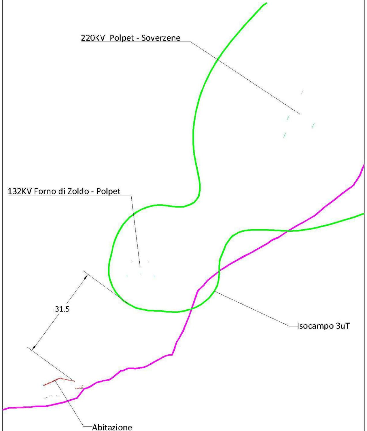
Sezione eseguita alla progressiva 14134 della linea 132KV Forno di Zoldo - Polpet (campata 41-42) comprensiva degli effetti della 220KV Soverzene-Polpet e della 220KV Polpet-Lienz (fuori scala)
