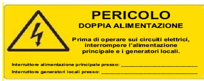
Figura 9.1 - Segnaletica da utilizzare per i lavori sugli impianti FV
