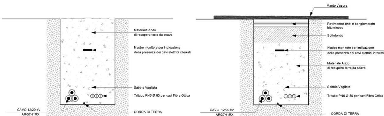
Figura 2.10 – Tipico modalità di posa Cavo MT 15 kV
