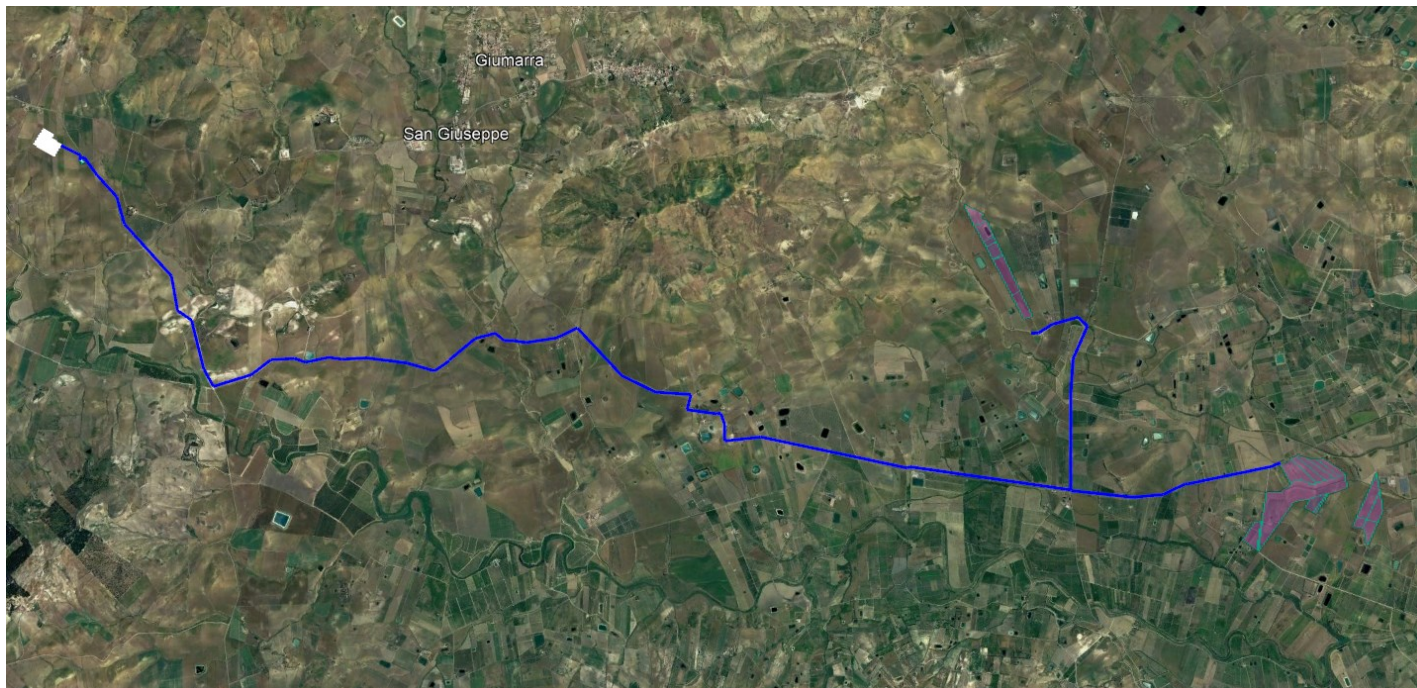
Figura 5 Area lotti fotovoltaici (in viola) con percorso cavidotto interrato (in blu) e area impianti di connessione alla rete (in bianco) su foto satellitare (fonte Google LLC.)
