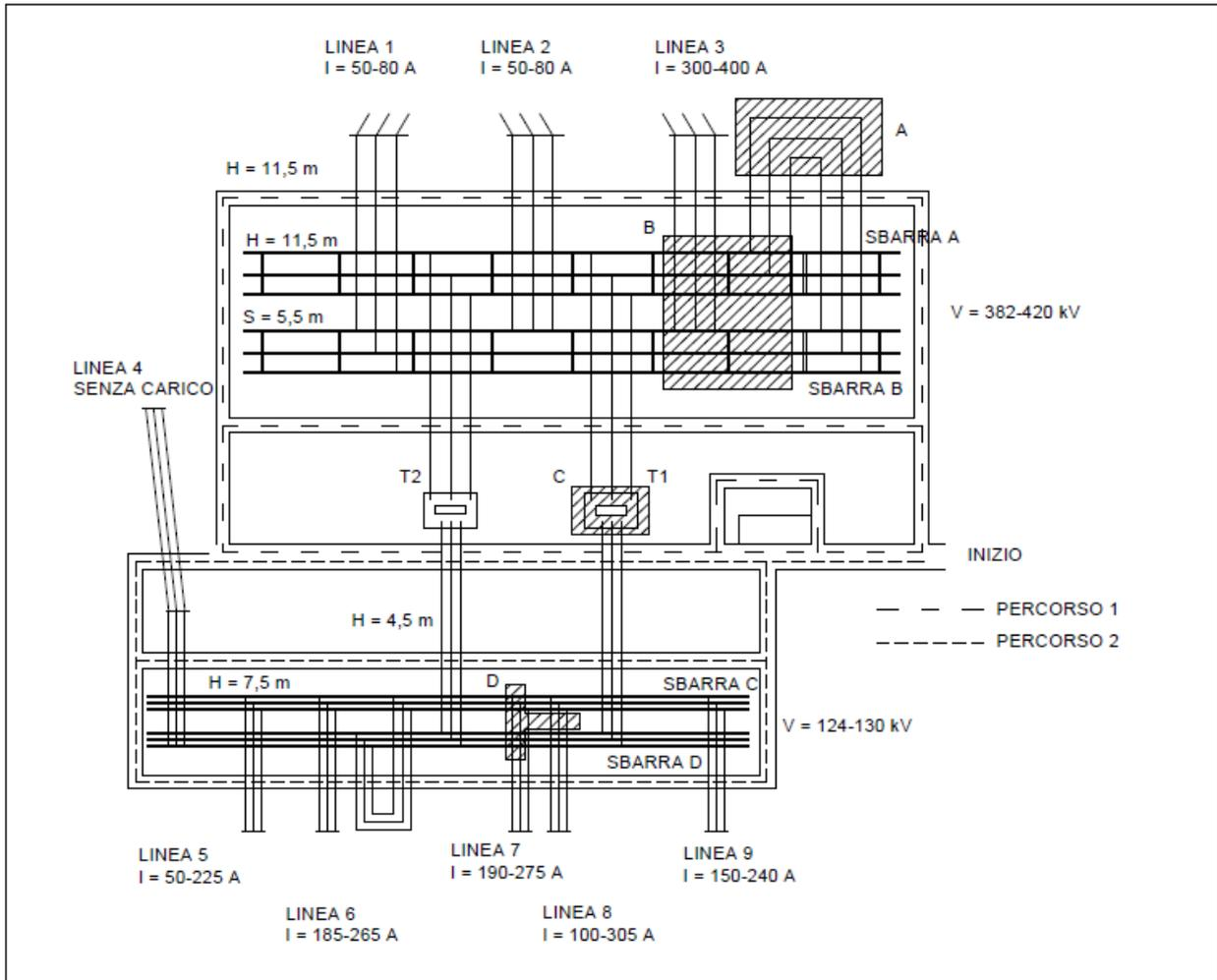
**Figura 11** Pianta di una tipica stazione 380/132 kV con l'indicazione delle principali distanze fase-fase (S) e fase-terra (H) e delle variazioni delle tensioni e delle correnti durante la fasi di misurazioni di campo elettrico e magnetico.
