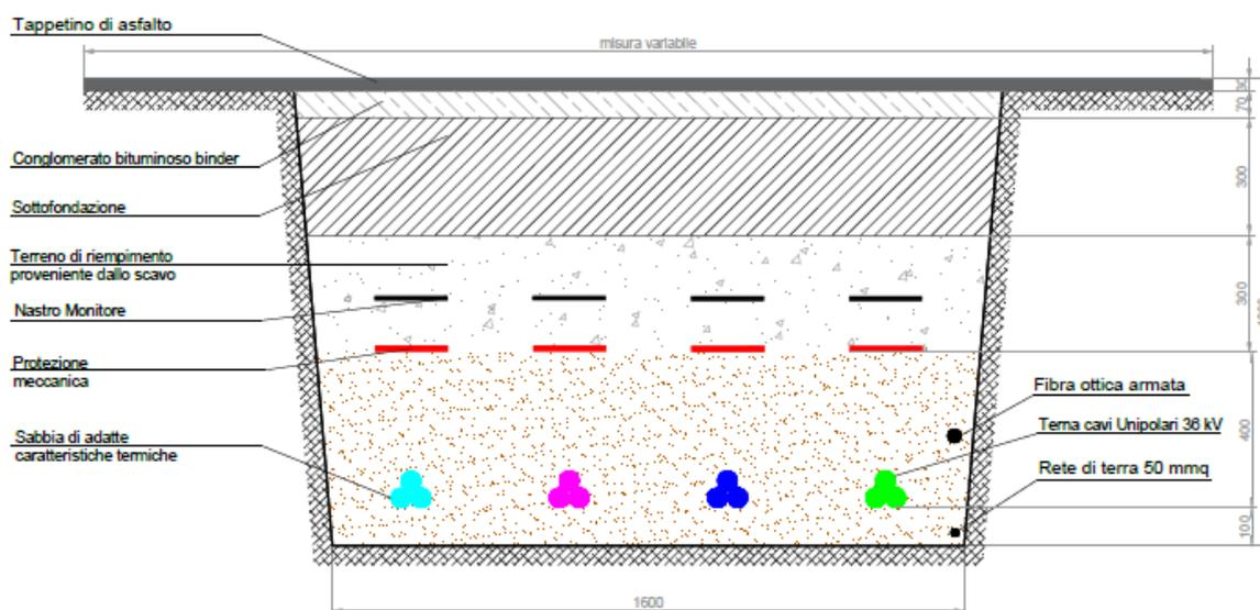
Figura 7 configurazione della sezione più sollecitata del cavidotto interrato
