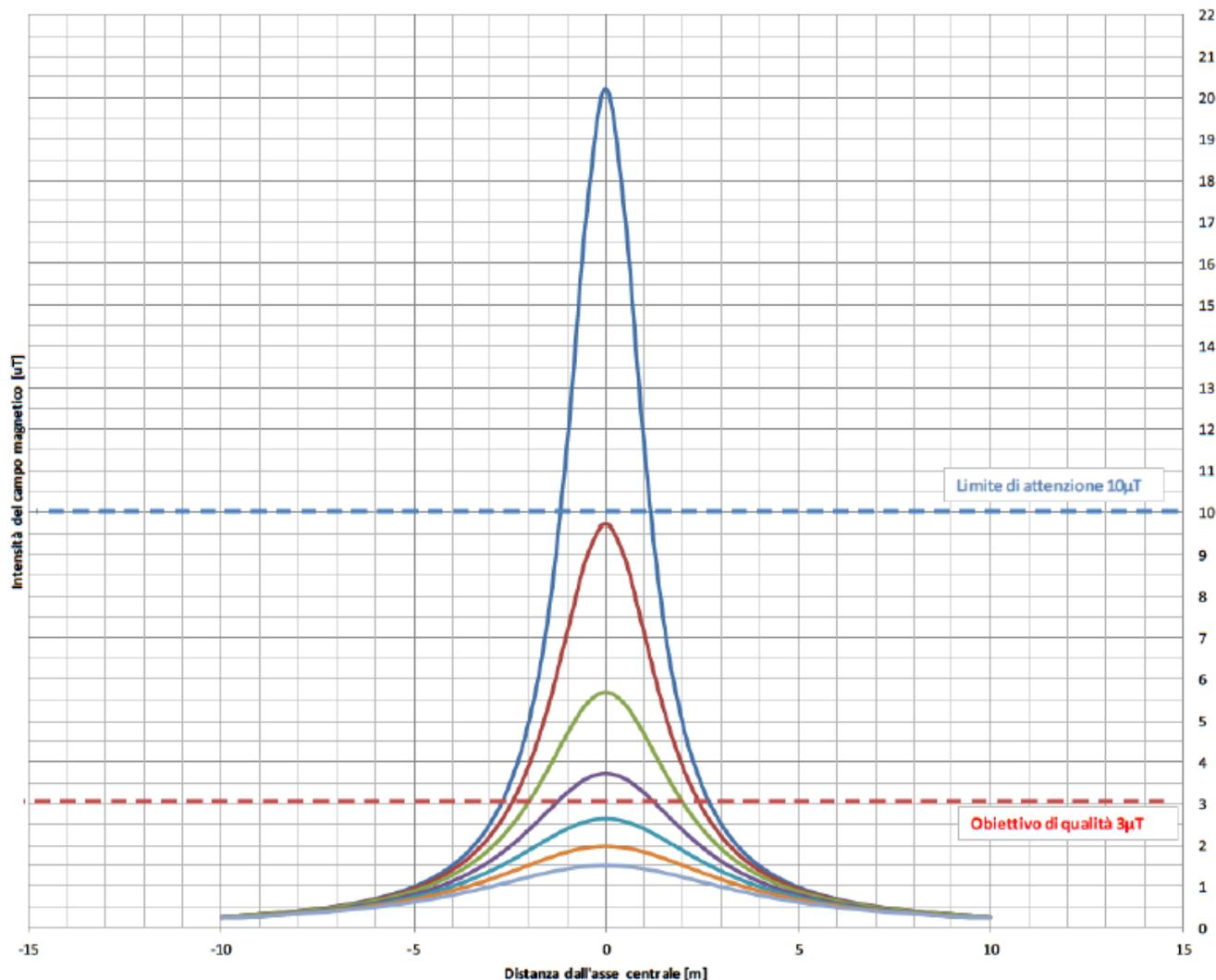
Figura 9 andamento tipico del campo di induzione magnetica generato da più terne di conduttori interrati a 30kV
