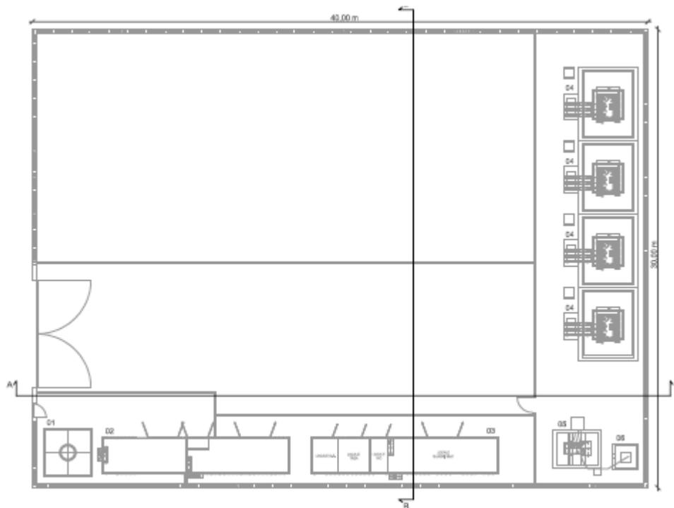
Figura 10 stazione elettrica di utenza a 36kV
