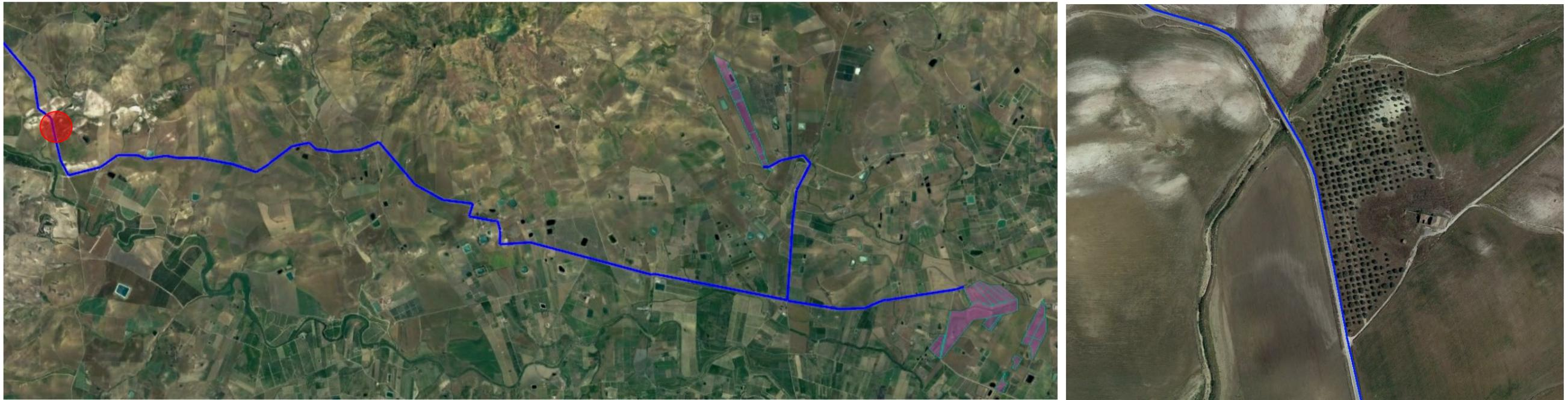
Figura 32. Interferenza (in rosso) del cavidotto interrato (blu) sul vincolo paesaggistico (Foto Google Earth)
