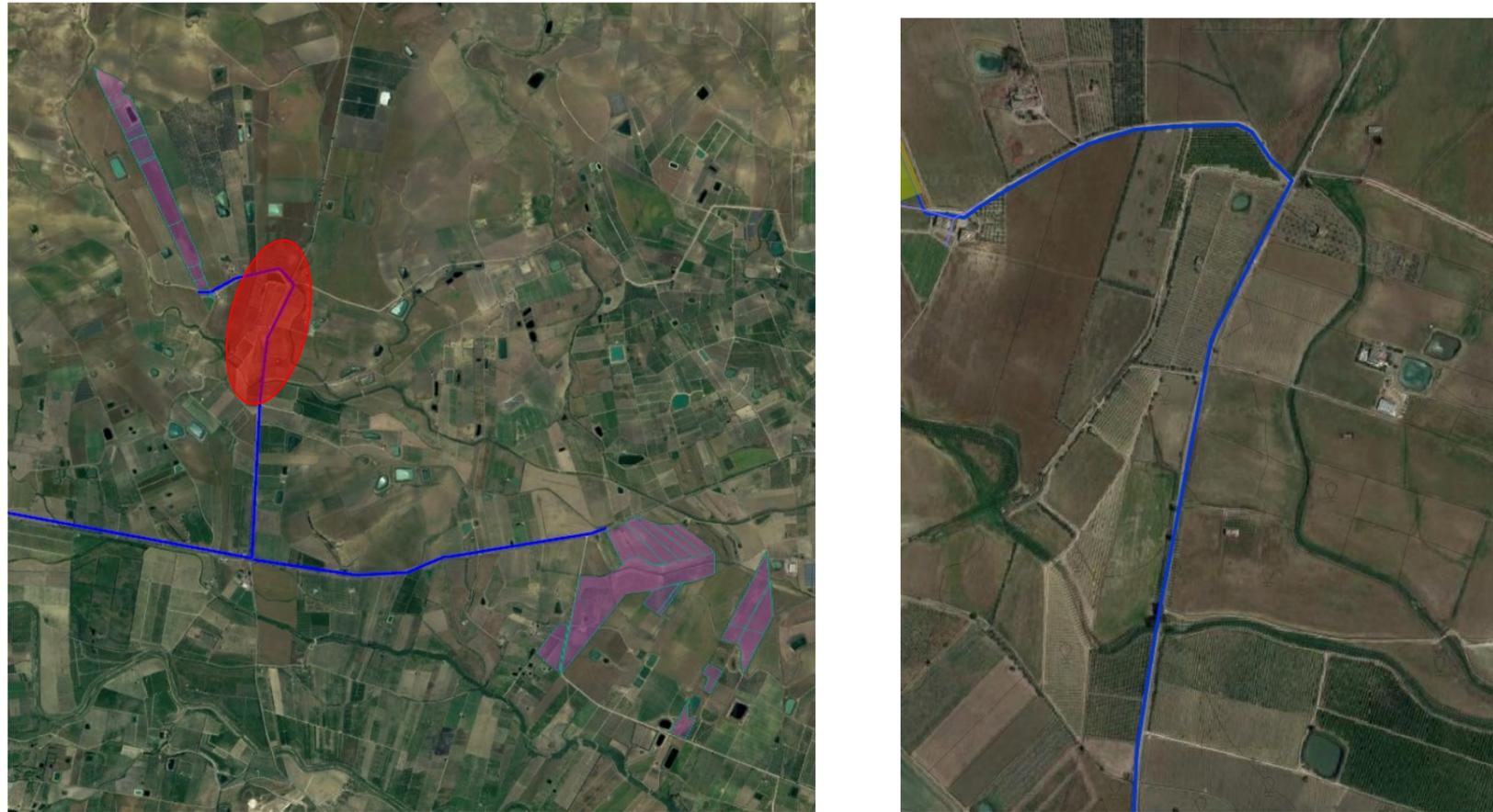
Figura 13. Interferenza (in rosso) del cavidotto interrato (blu) sul vincolo paesaggistico e aree boschiva (foto Google Earth)
