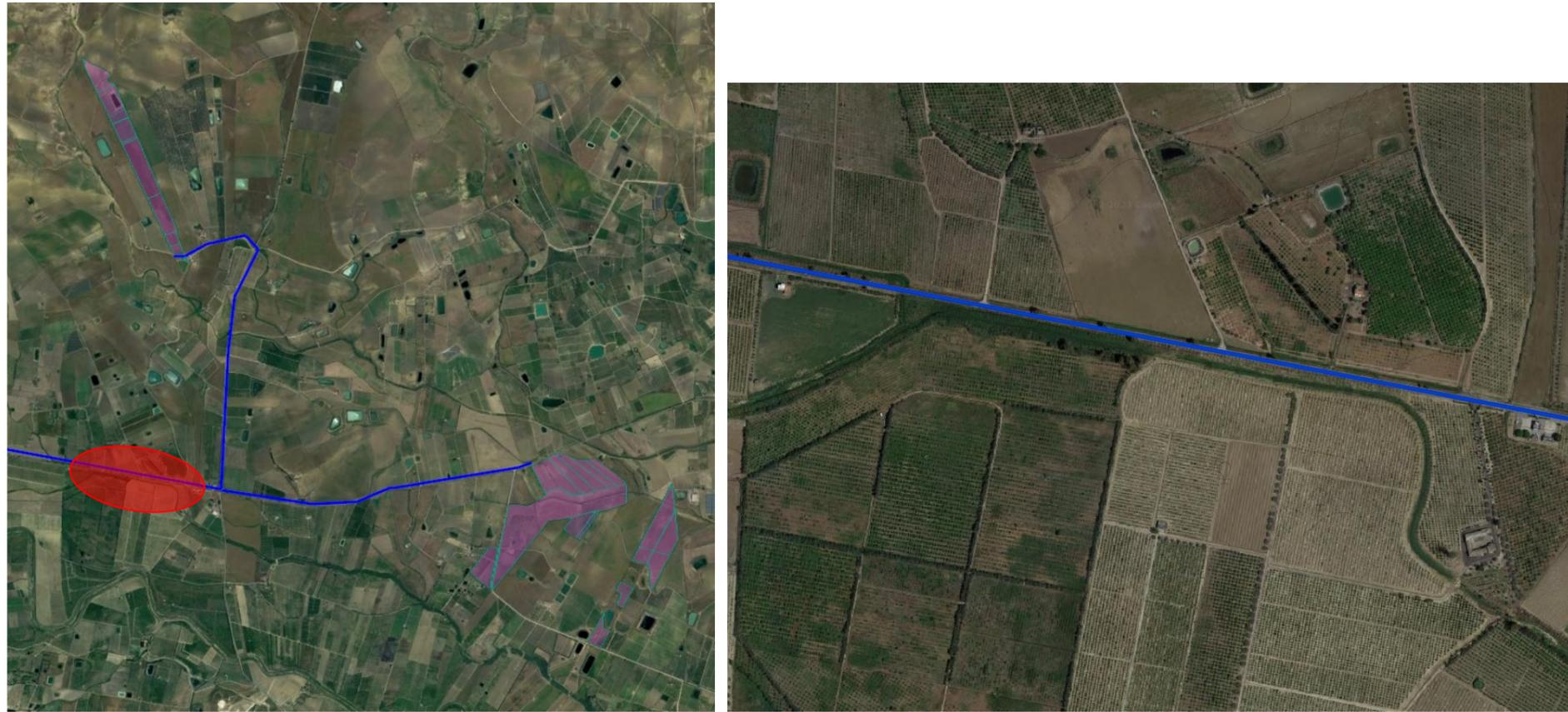
Figura 20. Interferenza (in rosso) del cavidotto interrato (blu) sul vincolo paesaggistico e aree boschiva (foto Google Earth)
