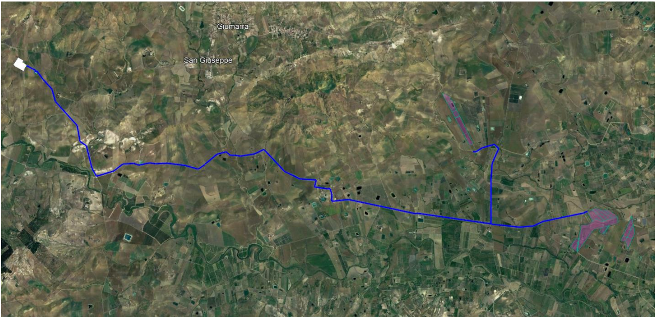
Figura 5 Area lotti fotovoltaici (in viola) con percorso cavidotto interrato (in blu) e area impianti di connessione alla rete (in bianco) su foto satellitare (fonte Google LLC.)
