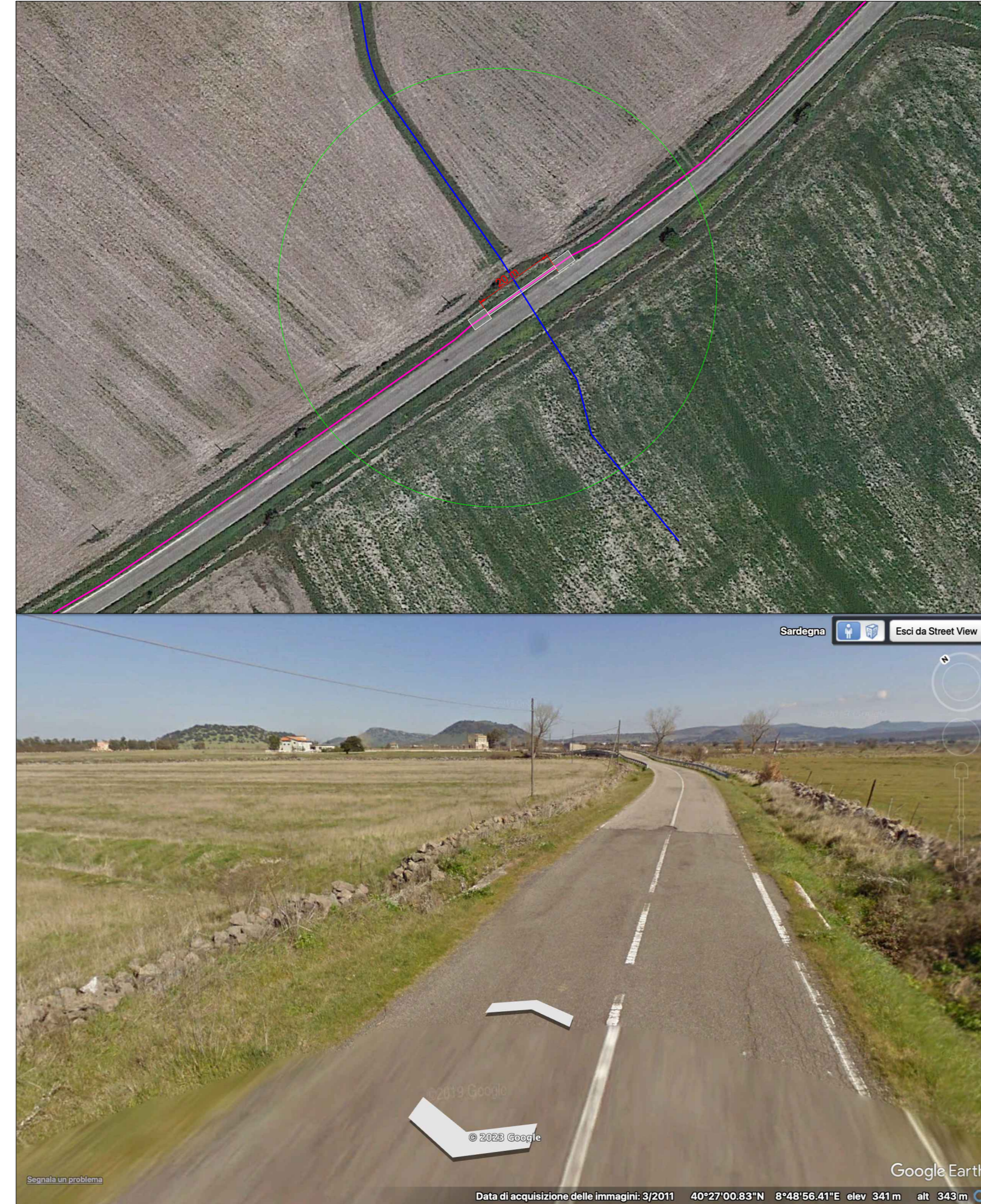
INTERFERENZA N. 2 - TOMBINO IDRAULICO Lungh. foro di trivellazione = 20 m Diametro foro = 90 cm
