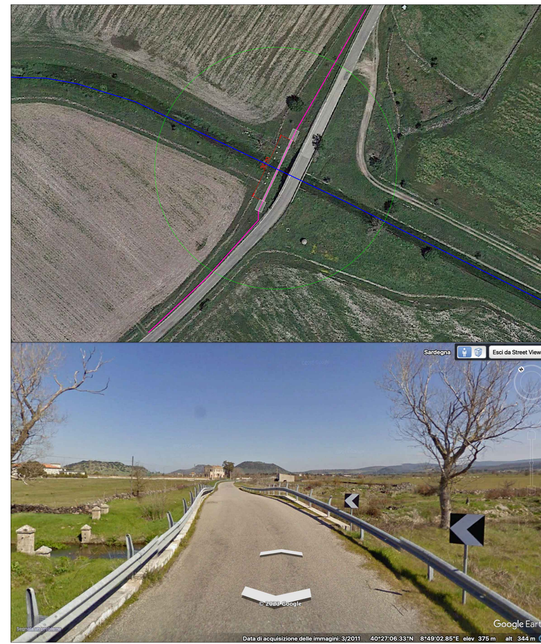
INTERFERENZA N. 3 - RIU LADU Lungh. foro di trivellazione = 30 m Diametro foro = 90 cm
