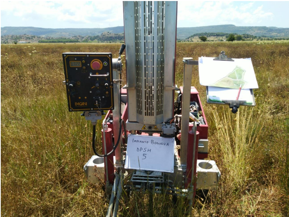
Figure 5: Postazione prova penetrometrica DPSH 5
