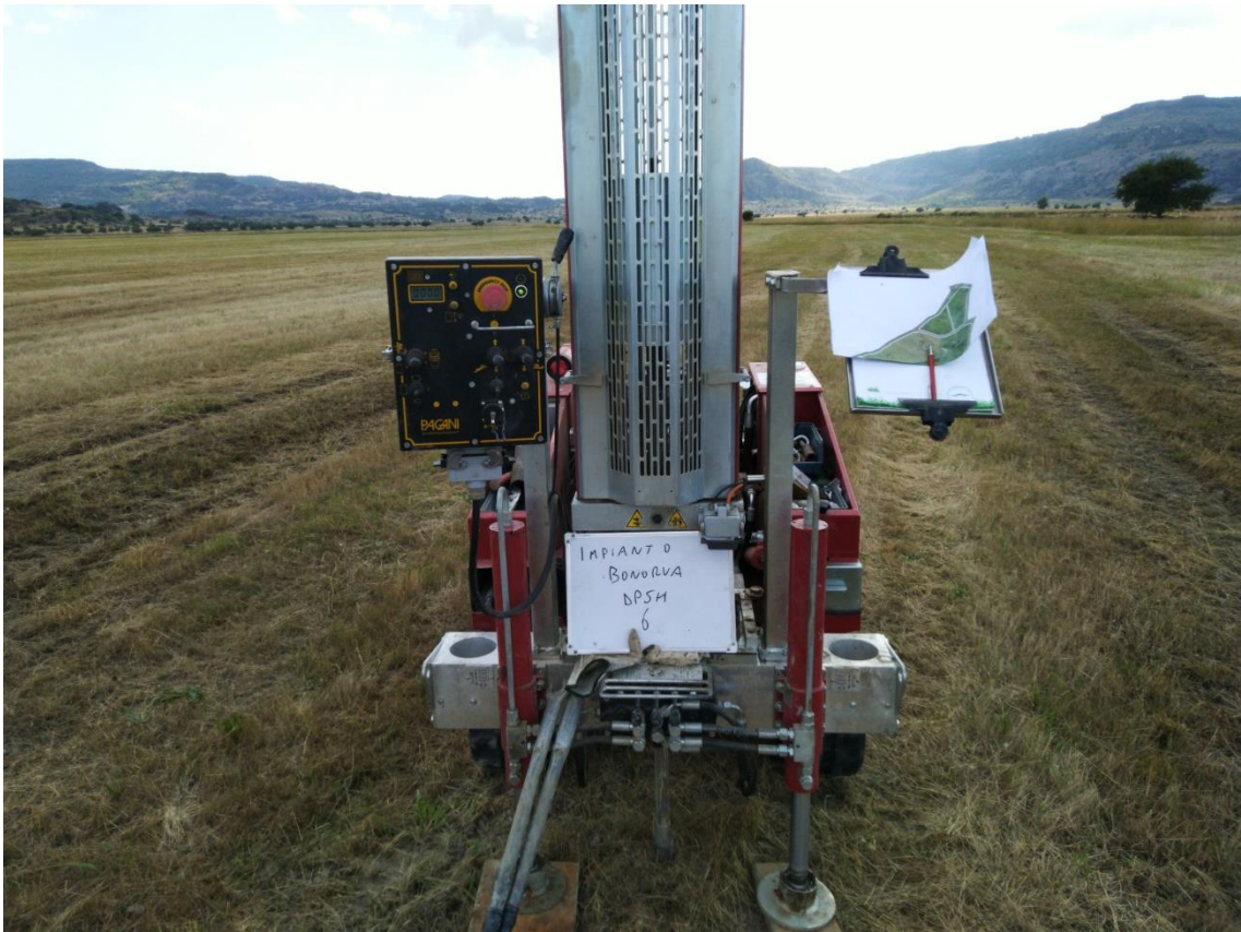
Figure 6: Postazione prova penetrometrica DPSH 6
