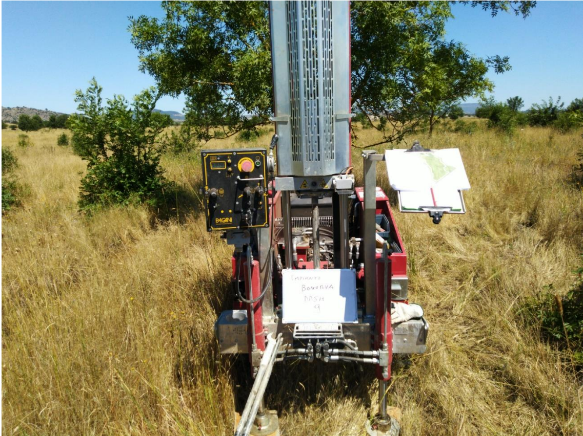
Figure 9: Postazione prova penetrometrica DPSH 9
