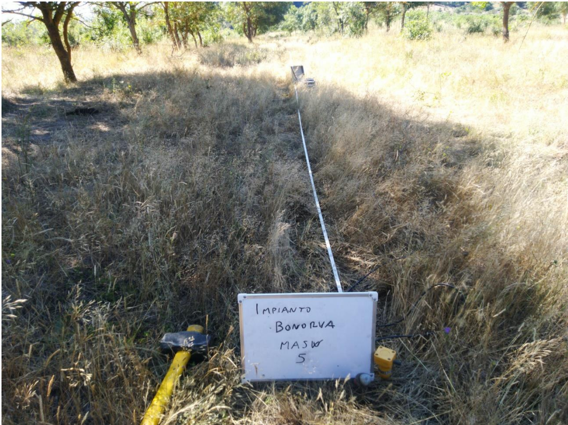
Figure 14: Postazione prova sismica MASW 5
