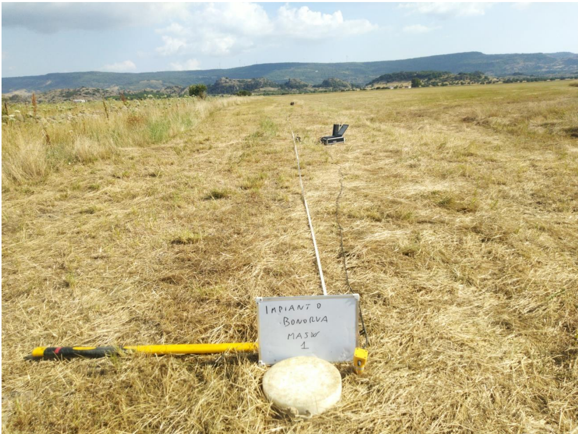
Figure 10: Postazione prova sismica MASW 1
