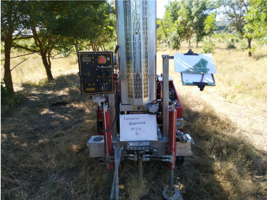
Figure 7: Postazione prova penetrometrica DPSH 7
