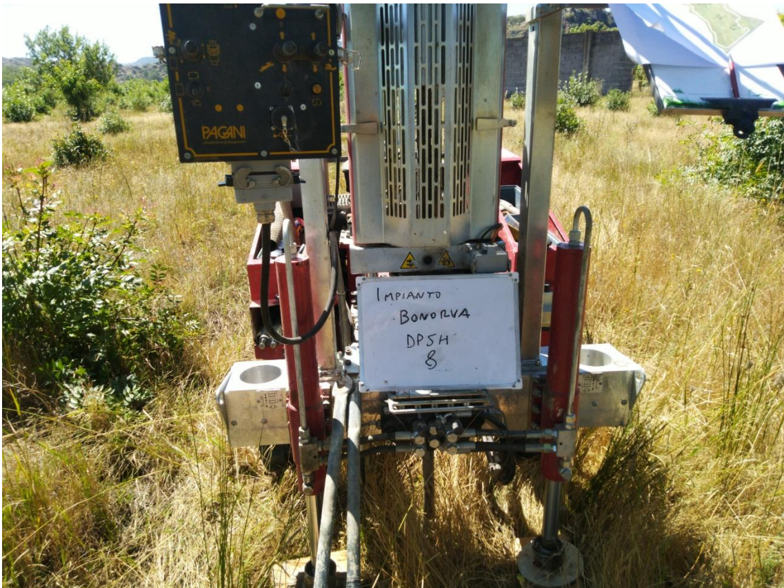
Figure 8: Postazione prova penetrometrica DPSH 8
