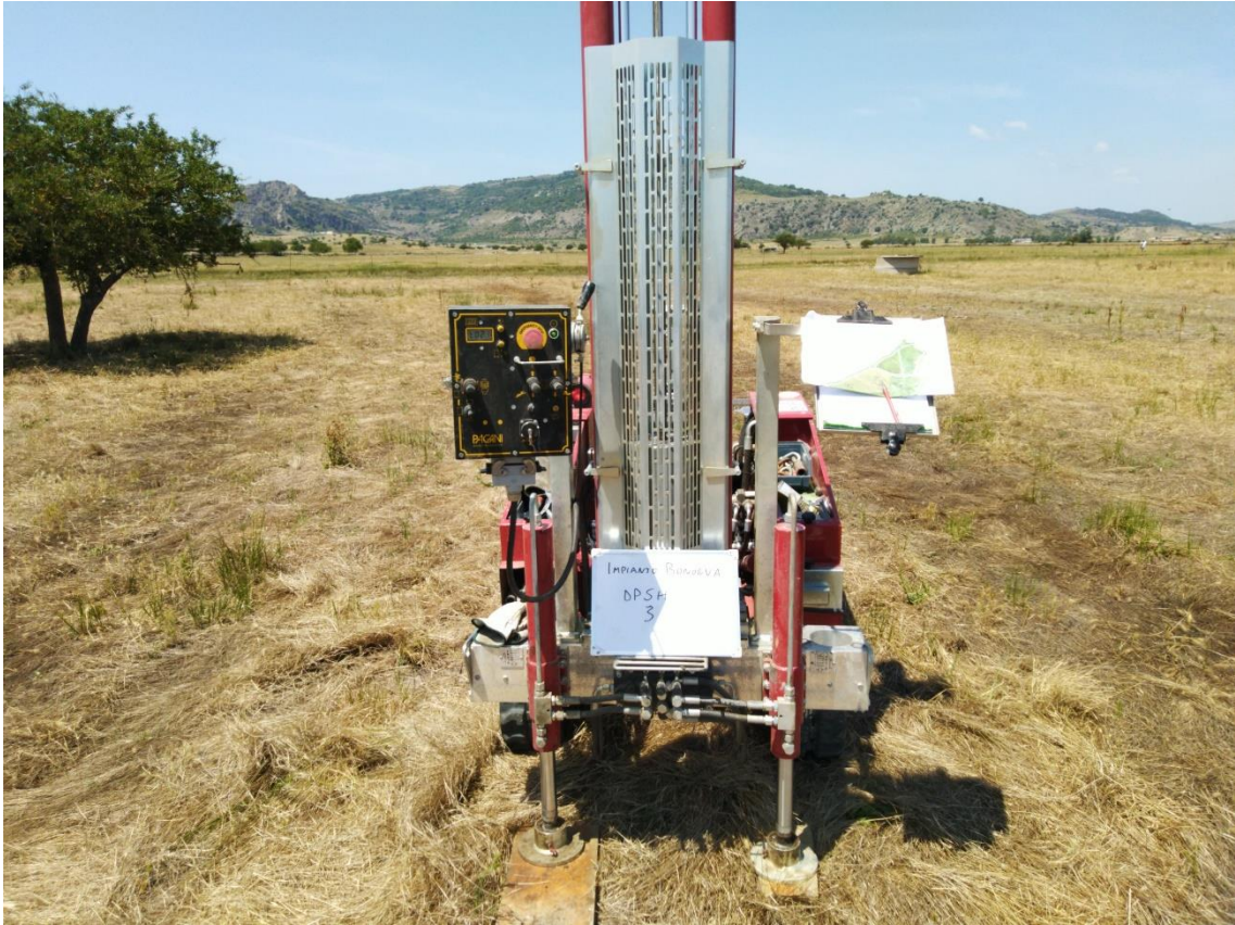
Figure 3: Postazione prova penetrometrica DPSH 3
