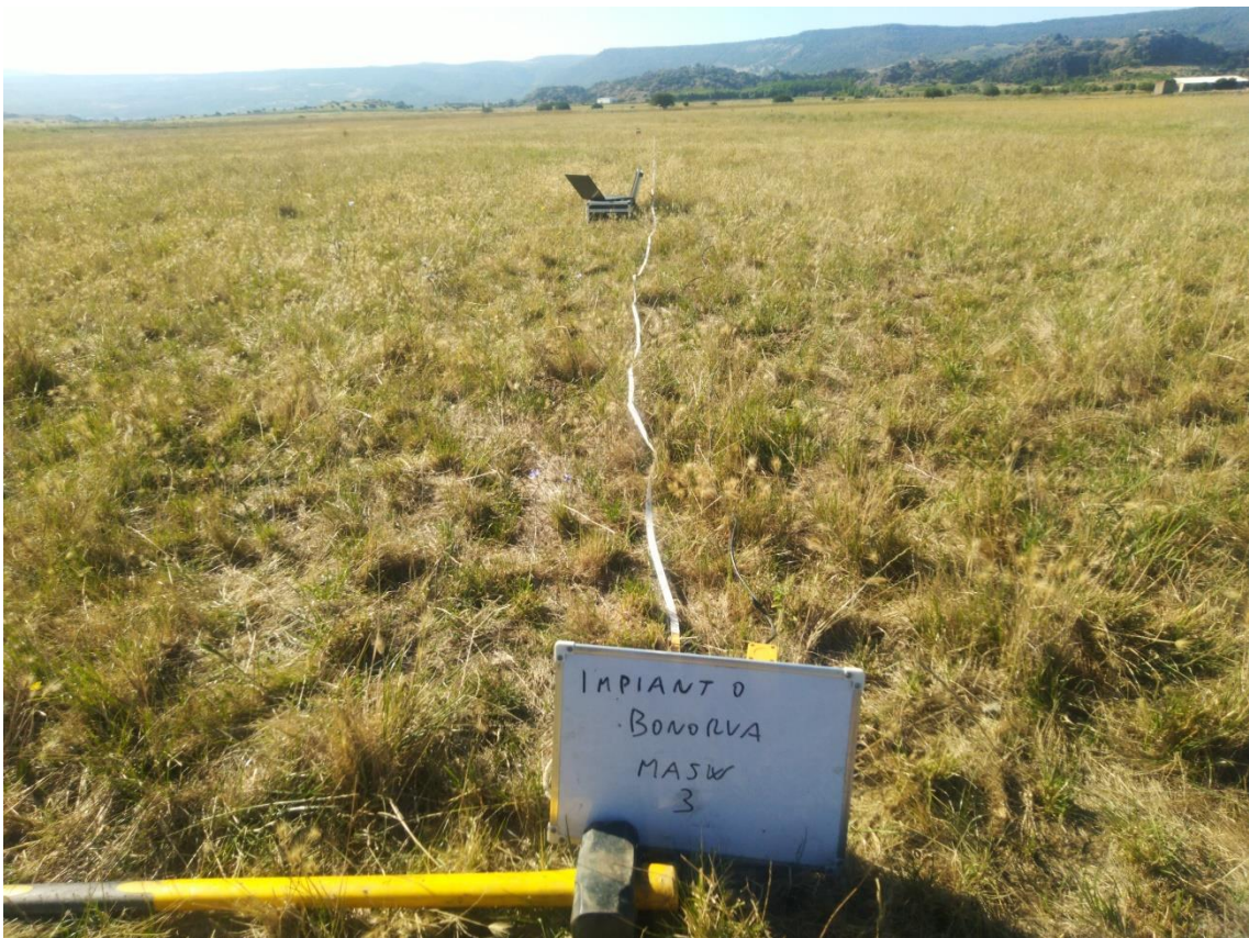
Figure 12: Postazione prova sismica MASW 3
