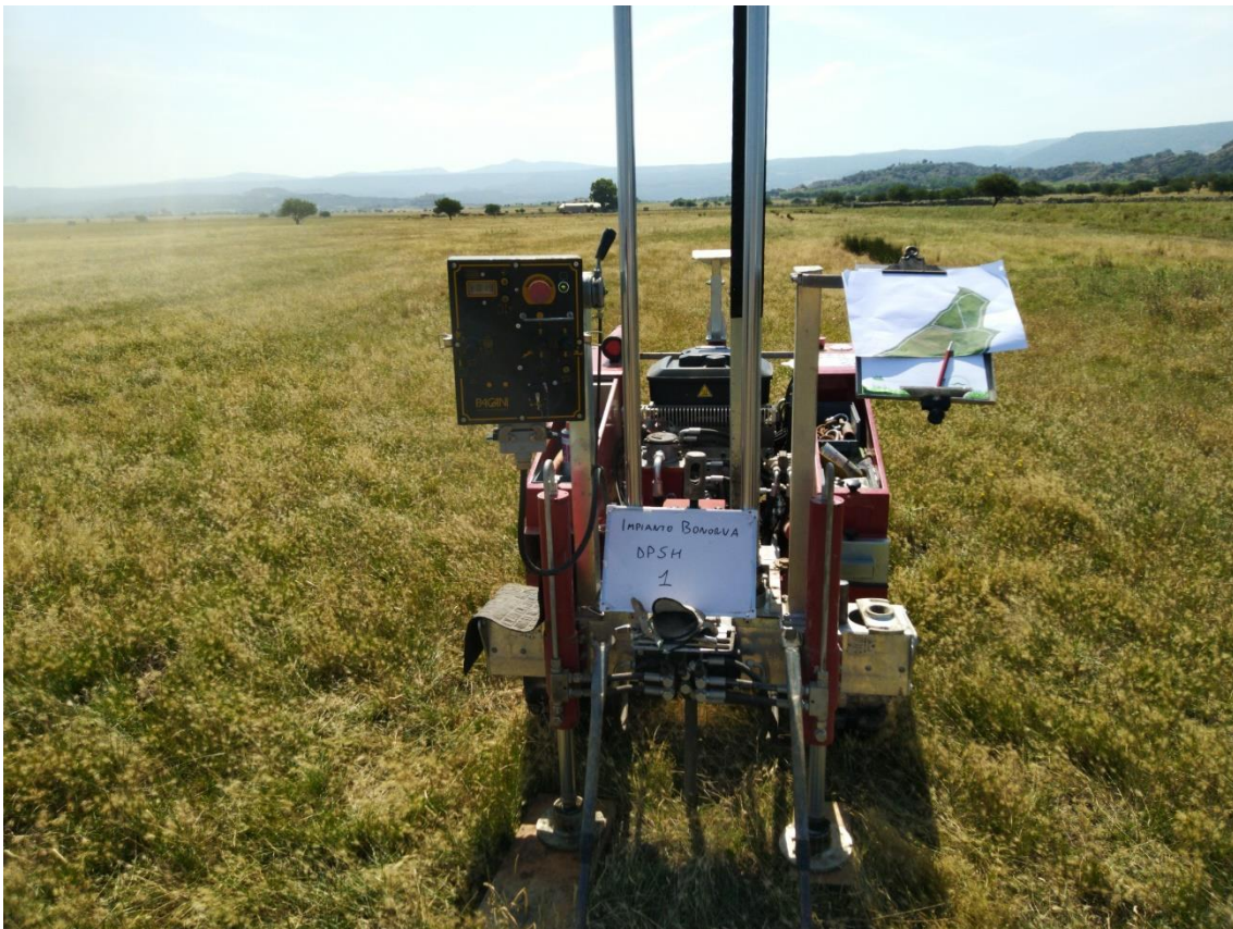
Figure 1: Postazione prova penetrometrica DPSH 1
