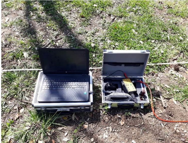
Figura 22: Sismografo DOREMI della Sara Electronic Instruments
