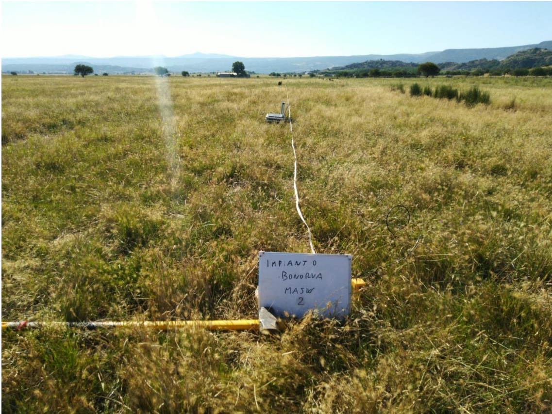
Figure 11: Postazione prova sismica MASW 2
