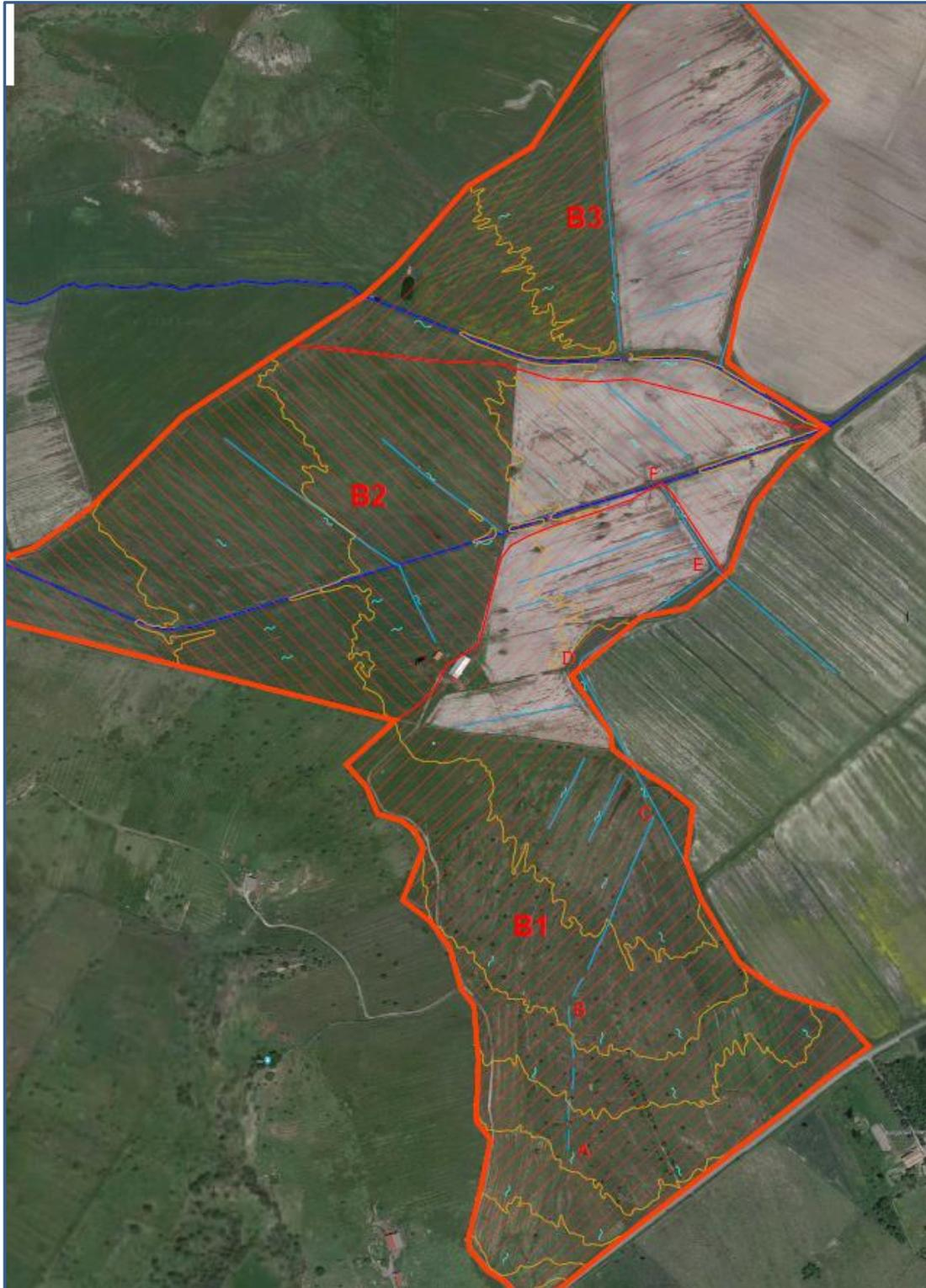
*Figura 15 - Canalini scolanti interni al campo fotovoltaico*
