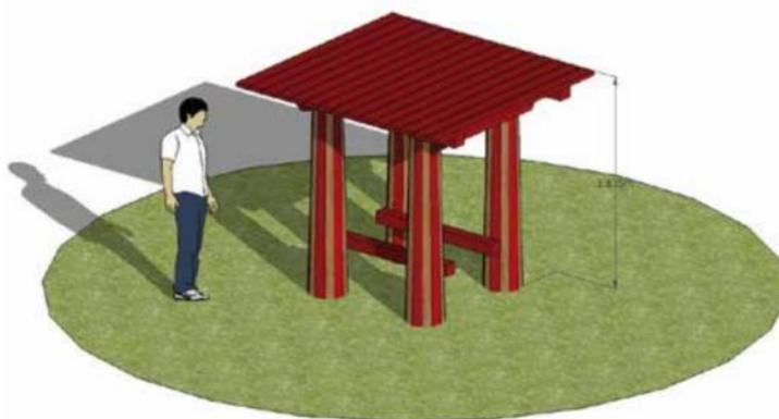
**Figura 28 - Tipologia costruttiva del carnaio realizzata nella Riserva Naturale Regionale Monterano. Altezza fuori terra dell'impalco: 1,8 metri. Larghezza del piano rialzato: 3x3 metri. Legno impiegato: castagno.**
