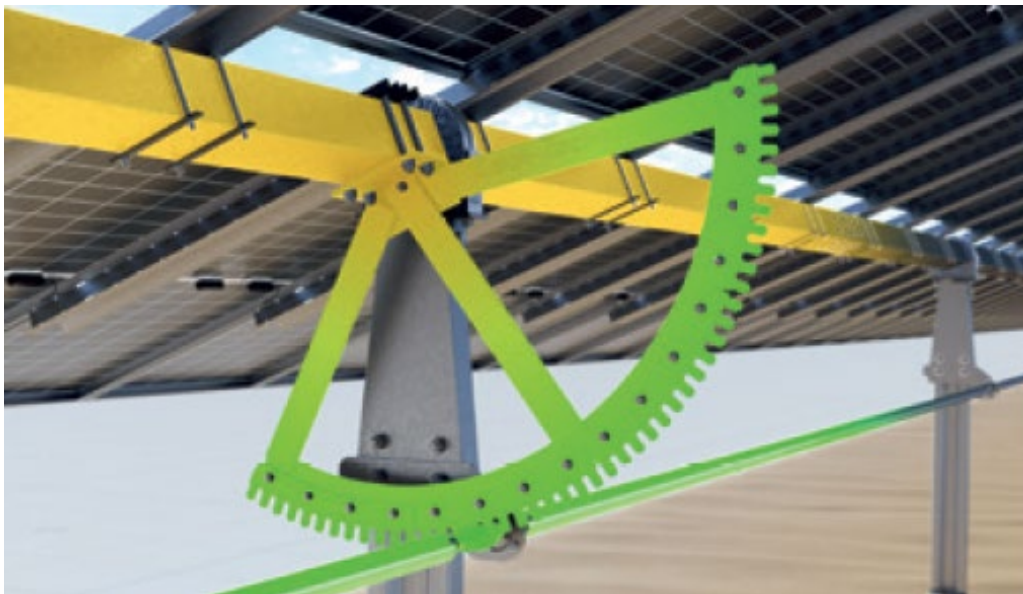
Dettaglio movimentazione con inseguitore monoassiale Est-Ovest
