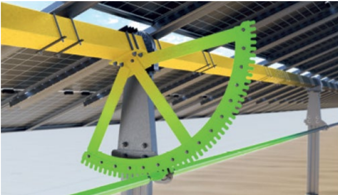
Dettaglio movimentazione con inseguitore monoassiale Est-Ovest
