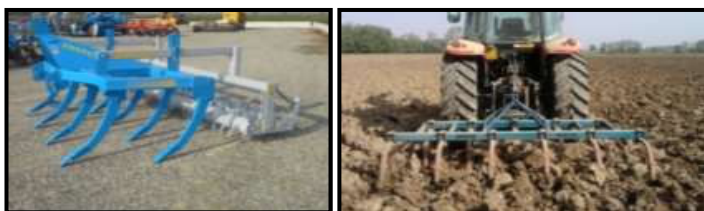
lavorazione del terreno eseguita con ripper
