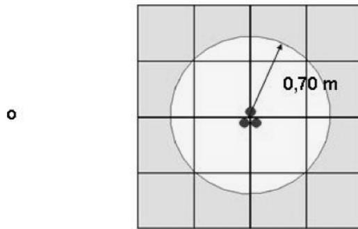
**Fascia di rispetto ( $B > 3 \text{ microT}$ ) per cavo interrato MT ad elica visibile (passo d'elica 3 m) – sez. 185 mm<sup>2</sup> – In 324 A**
