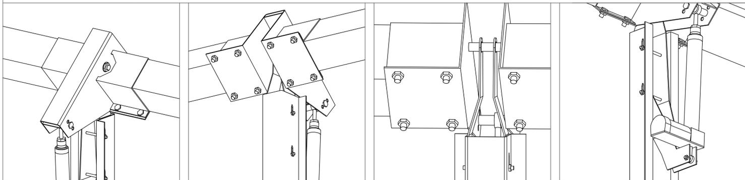
**PARTICOLARE COSTRUTTIVO\_Compenti Struttura / Angolo di rotazione**
