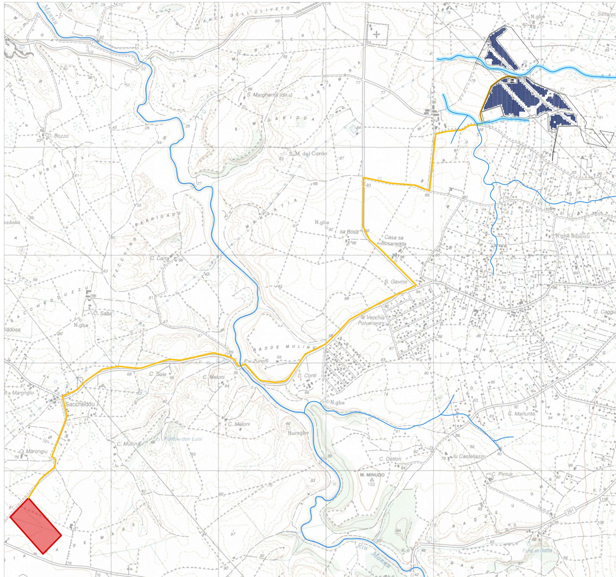
AREA D'IMPIANTO CON PERCORSO CAVIDOTTO SU CARTOGRAFIA I.G.M. E CORSI D'ACQUA scala 1 : 10 000
