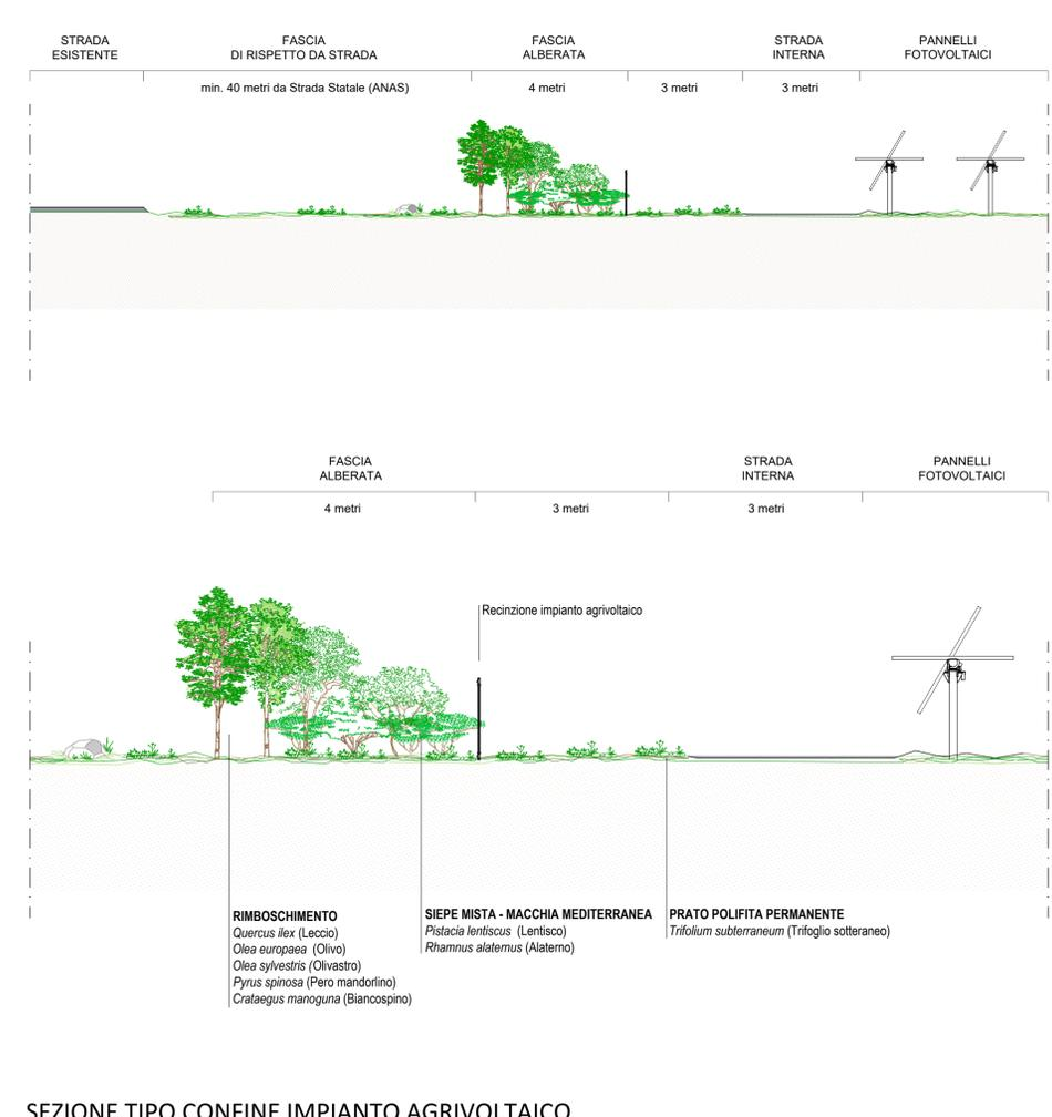
SEZIONE TIPO CONFINE IMPIANTO AGRIVOLTAICO
