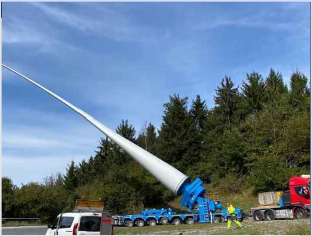
Trasporto pala con Blade Lifter "Le pale saranno opportunamente stoccate in area preposta e successivamente trasportate in sito".
