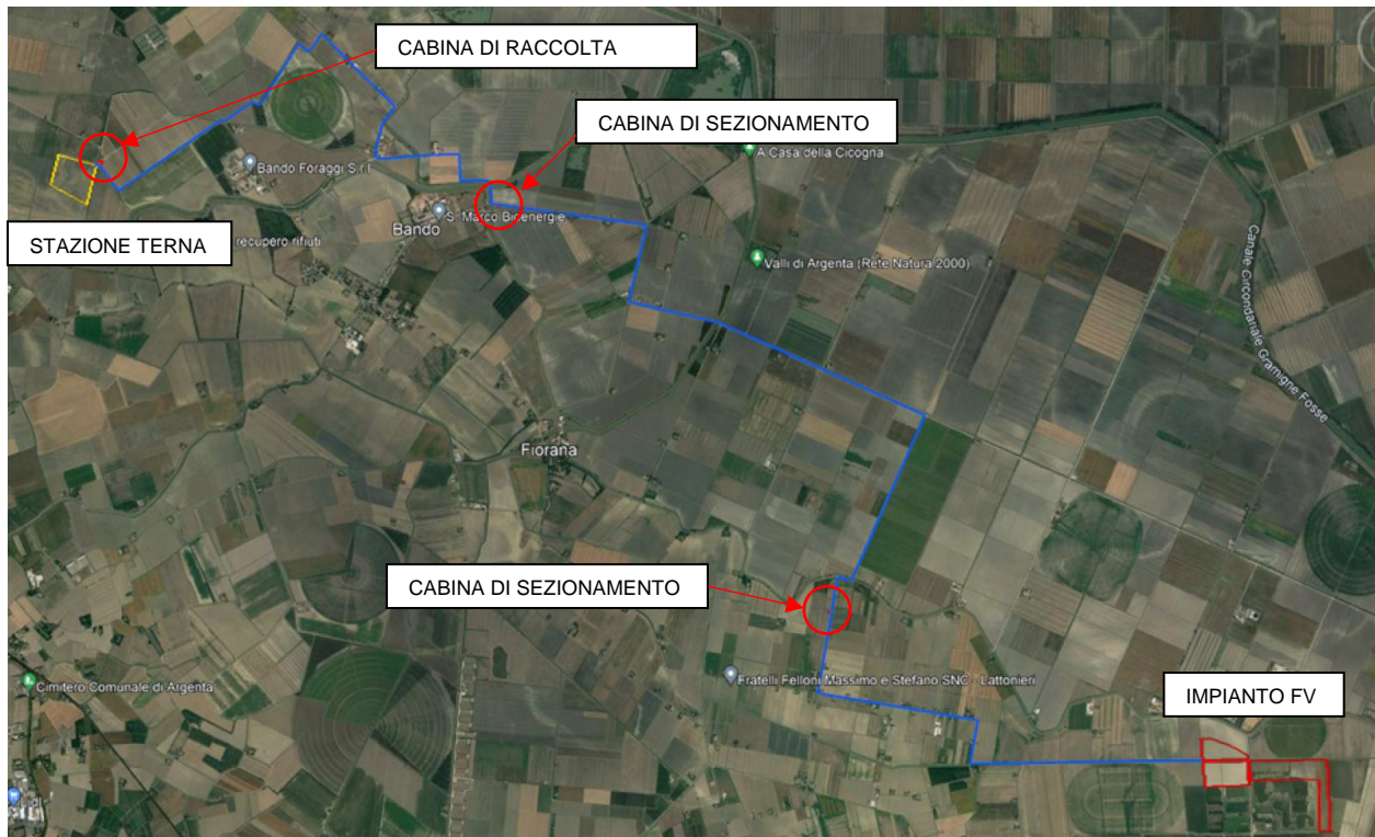
FIGURA 11: INQUADRAMENTO CABINE DI RACCOLTA E SEZIONAMENTO
