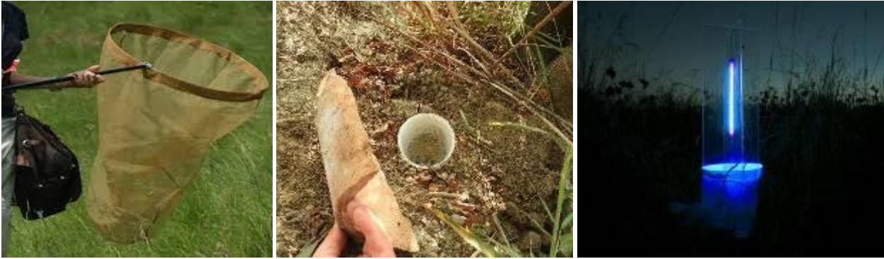
Figura 3. a) Retino entomologico (a sx), b) Trappola a caduta (al centro), c) Trappola luminosa (a dx).
