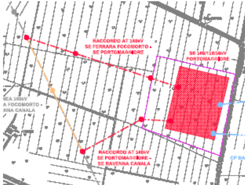
Raccordi con la linea 380 Kv
