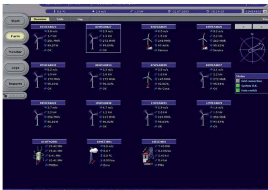
Figura 4 Monitoraggio remoto di una Wind Farm
