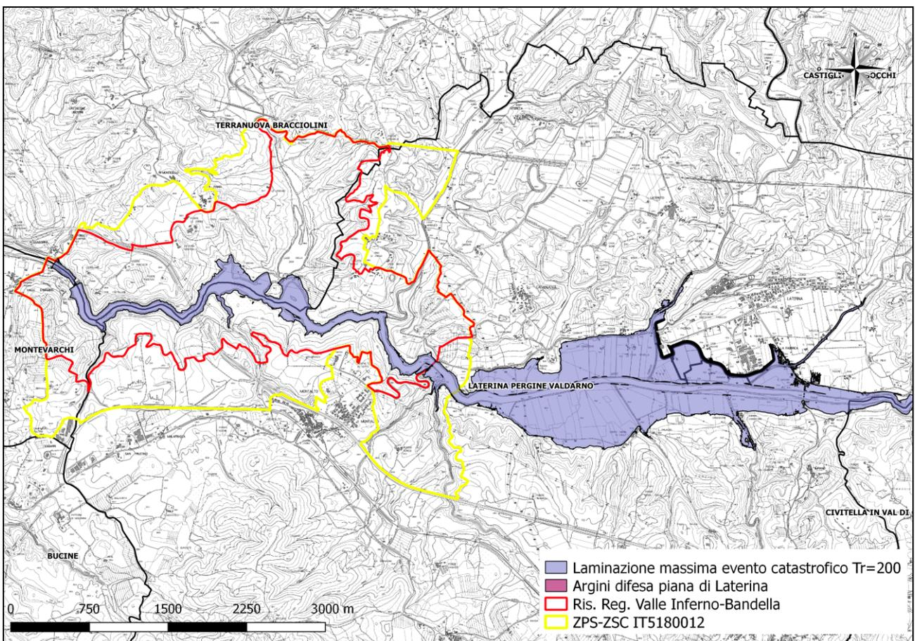
Figura 5 - Evento catastrofico  $Tr=200$  anni,  $d=12$  ore. Laminazione massima, Piana di Laterina e Area di Progetto considerando eseguito il sopralzo della diga di Levane e le arginature protettive a Laterina
