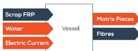
Occorre segnalare che tale processo, rispetto ad una tradizionale macinazione meccanica, offre una qualità delle fibre migliore, generalmente con materiali restituiti ovvero fibre più lunghe e più pulite.
